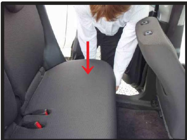
⑤③の赤矢印部（2ヶ所）を意識し、シートを真上に引き上げると、固定しているクリップが外れます。
