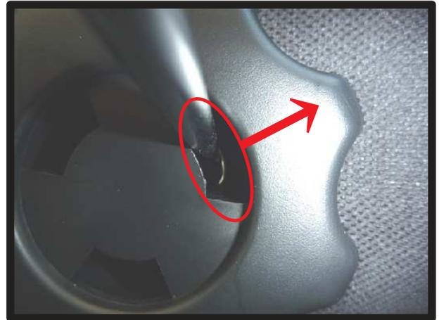
④リフターのダイヤルはピンで固定されています。フタを外すと、図のように隙間からピンが見える箇所がありますので、先の細いものでピンを外側にずらすと外れます。
