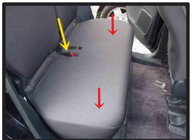
③シートは矢印の3点で固定されています。黄色の矢印部はボルトで、赤色の矢印部はクリップで固定されています。
