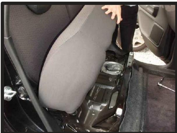
⑥固定されている3点を外すと、図のようにシートが取り外せます。
