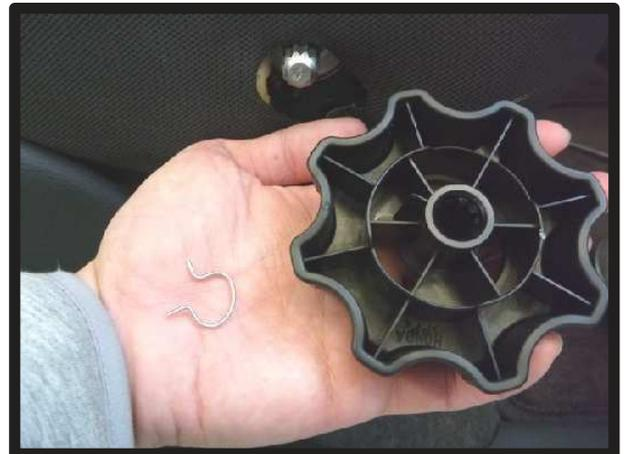
⑤ピンを外すと、ダイヤルは手前に真っ直ぐ引き抜く事が出来ます。図は、取り外したダイヤルとピンです。
