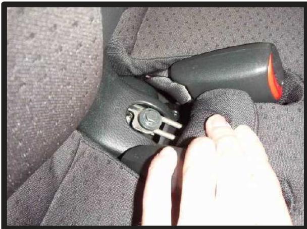
④③の黄色の矢印部のシートをめくると、図のようにボルトで固定されていますので、ラチェット等を使用し取り外します。
