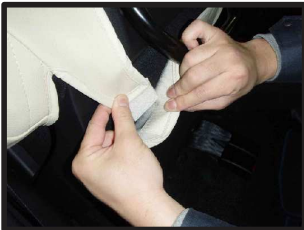
⑥④で入れ込んだ生地をマジックテープでシートに直接固定します。この際、底面のカバー左右にあるマジックテープの付いた生地も一緒に固定します。
