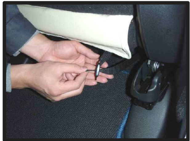
⑩1ページ⑥で引き出した生地についているバックルに、ベルトを通します。
