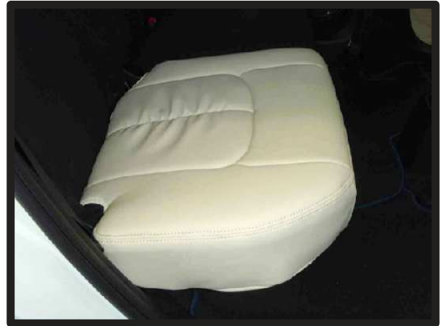
⑧跳ね上げた座面を元に戻し、シートのラインを整え、2列目運転席側座面の完成です。※シートベルトは、まだ戻さないで下さい。助手席側も一部形状が異なりますが同様に取り付けます。
