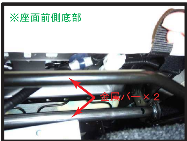
⑨カバー前側に付いているベルトは、図の2本の金属バーの上へ通して、座面裏側へ引き出します。
