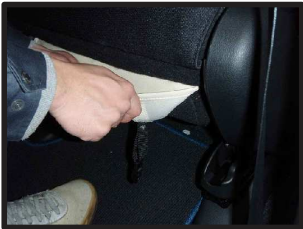
⑦引き出した生地は、座面にマジックテープで直接固定します。
