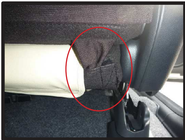
⑦シートヒーターやサイドエアバッグ 装備車の場合は、図のように配線 をかわすようにして下さい。
