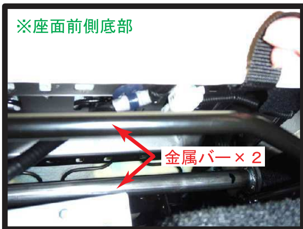
⑧カバー前側に付いているベルトは、 図の2本の金属バーの上へ通して、 座面裏側へ引き出します。
