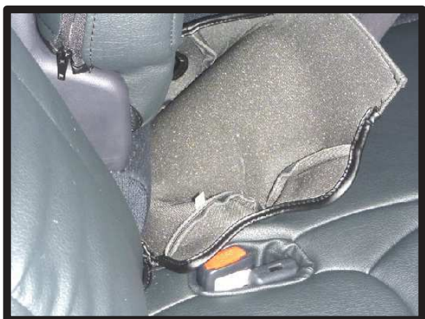
⑧2列目アームレストの下部です。アームレスト下部分と座面の隙間に部材の付いた生地を入れ込みます。
