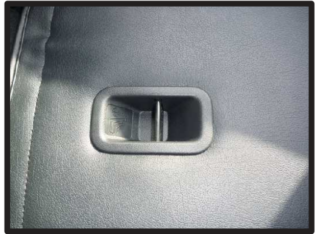
㉒シート背面のチャイルドシート固定用フック部にも、同様に生地を入れ込みます。隙間が狭いので少しずつ慎重に作業して下さい。
