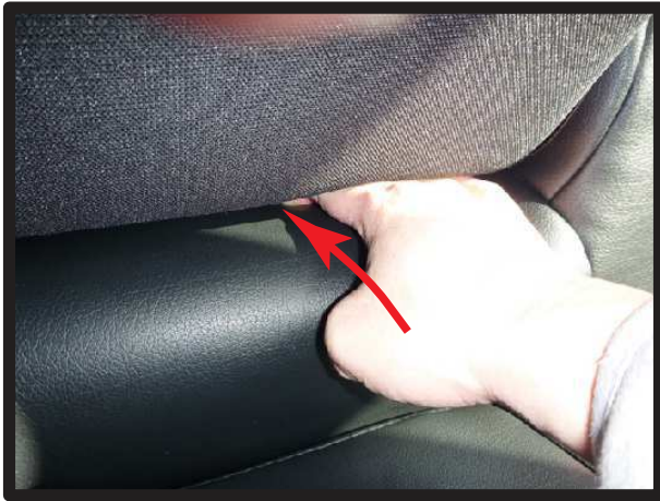
⑱アームレスト下部の隙間に生地を入れ込みます。
