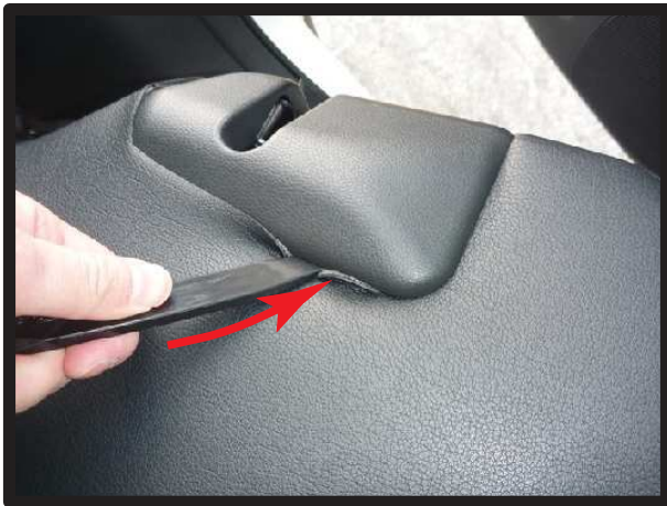
㉓図のプラスチックパーツ部の隙間にヘラ等を使用し、生地を入れ込みます。
