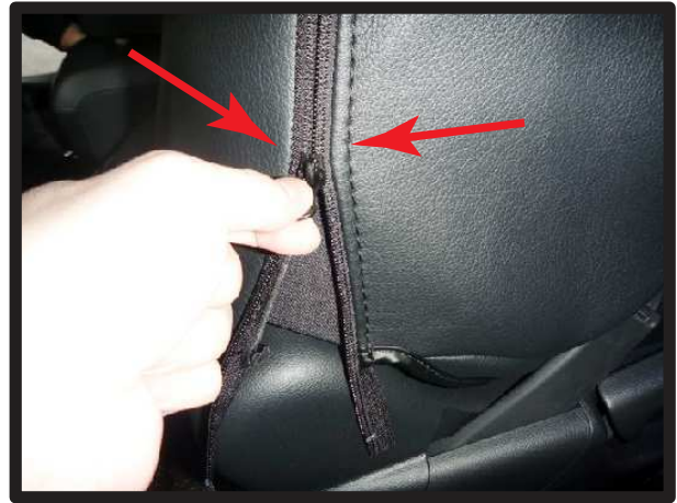
⑩カバー側面のファスナーを閉じます。生地同士を内へ寄せながら、慎重に閉じて下さい。
