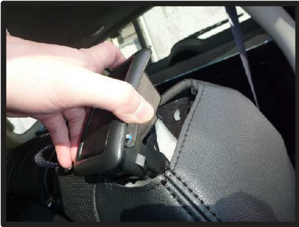
⑬ネジを外すと、リクライニングレバーが取り外せます。
