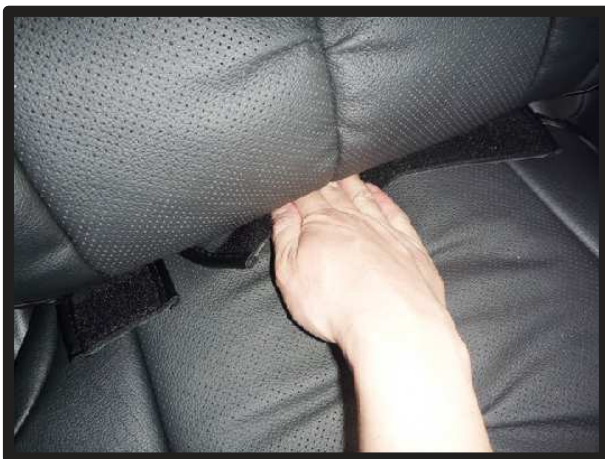
⑨背もたれと座面の隙間に生地を入れ込みます。
