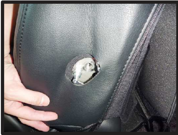
⑦アームレスト取り付け部は、図のようにカバーの加工穴でかわします。
