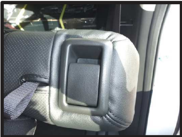
⑮リクライニングレバー周辺の生地を挟み込むようにし、元に戻します。
