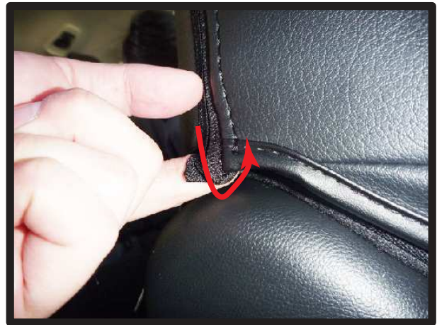
⑪閉じたファスナーの余りを、カバーの内側へ入れ込みます。
