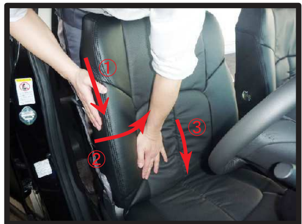
⑫図の①～③の順番に生地をなで下ろしてシートに密着させるようにしわを無くしていきます。
