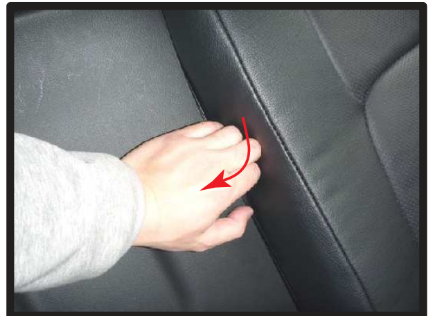
⑯側面の生地には、板状のプラスチックが付いていますので、アームレスト収納部のプラスチックパーツの隙間に板状のプラスチックを挟み込むように生地を入れ込みます。
