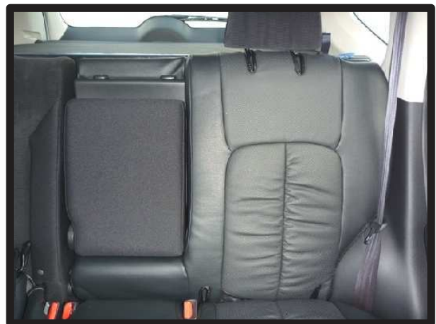
㉖カバーのラインを整え、2列目助手席側背もたれの完成です。運転席側も一部形状が異なりますが同様に取り付けます。
