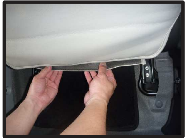
⑩3ページの⑤で入れ込んだ生地を後ろ側から引き出します。
