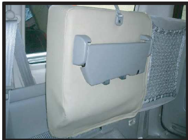
⑤足部分のプラスチックカバーをシートカバーを挟むようにして取り付け直します。
