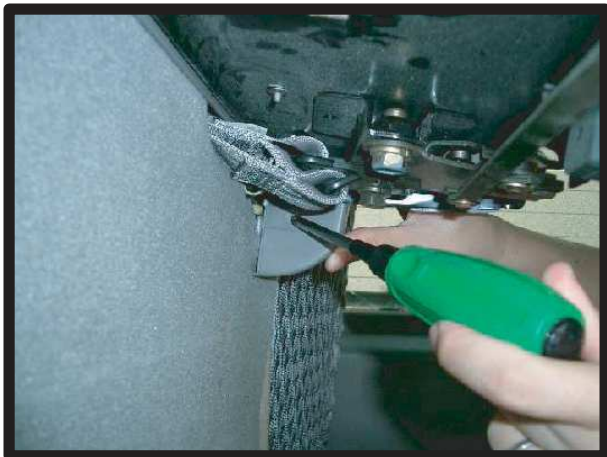
①座面を跳ね上げて足部分のプラスチックカバーを外します。
