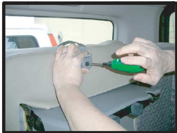
④シートカバーの穴に合わせて固定用ベルトを取り付けます。マジックテープ部分をそれぞれ固定します。
