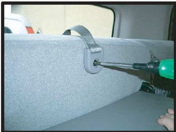
②跳ね上げ時の固定用のベルトも外します。
