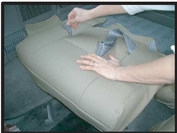
③座面を下ろしてシートカバーを前側からかぶせます。シートベルトとリクライニング用のつまみを穴から取り出します。
