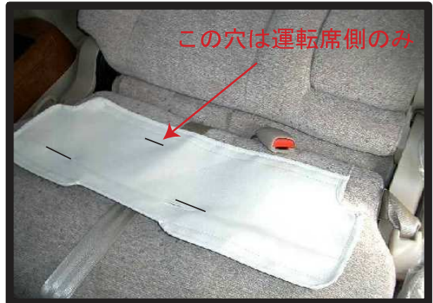
⑦シートカバーを図の向きに取り付けます。2つの穴はチャイルドシート用フックの位置になります。フックを使用される場合はフック部分のカバーを外しておいてください。
