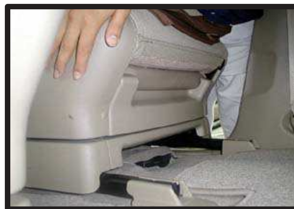
⑨プラスチックカバーを元通りに取付けて、1列目座面の完成です。
