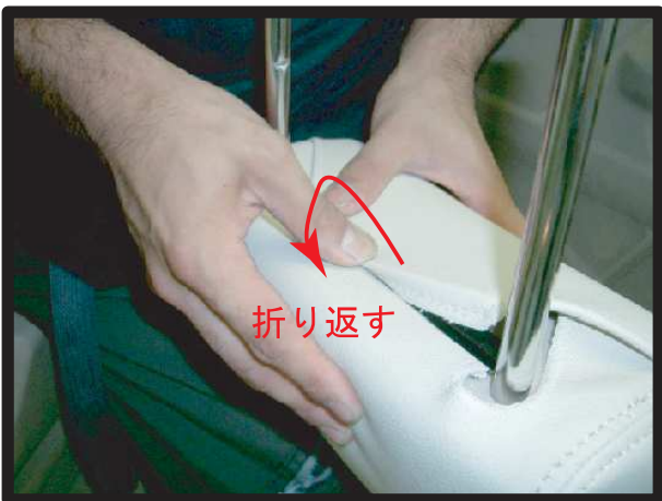
⑤平らなプラスチックの付いた部分を内側へ巻き込むように折り返して、カギ状のプラスチックの溝に押し込んでいきます。
