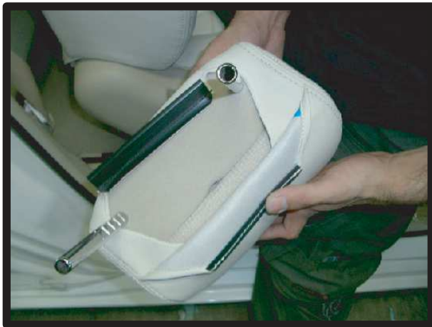
④ヘッドレストを背もたれから取り外して、底面のカバーをかぶせます。
