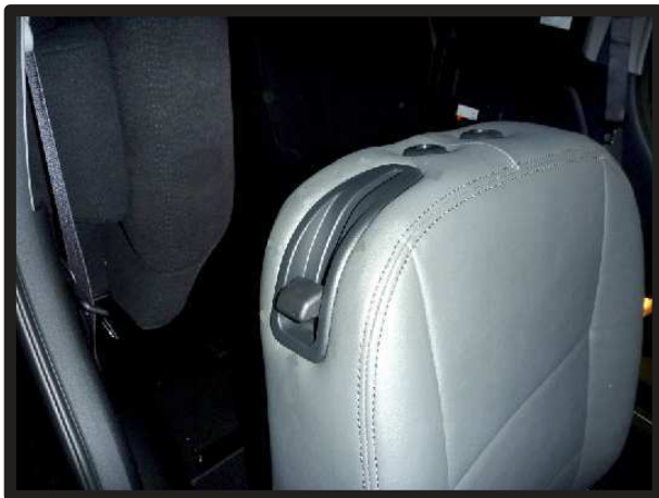
⑤プラスチックパーツの隙間に生地を入れ込むと図のようになります。
