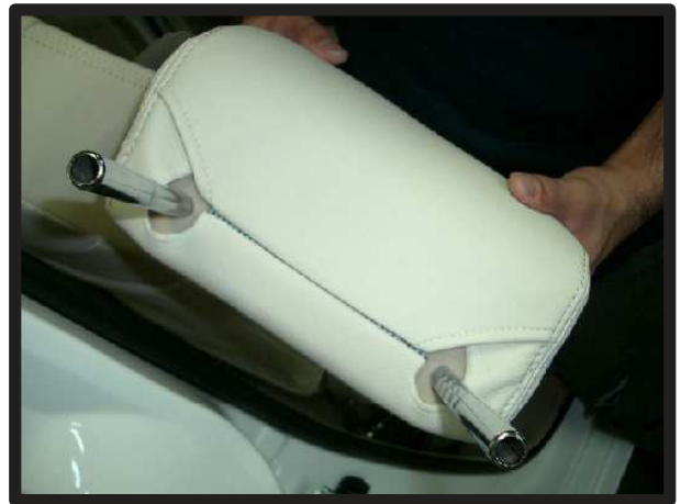
⑥最後まで入れ込むと図のようにプラスチックの部分が見えなくなるようになります。
