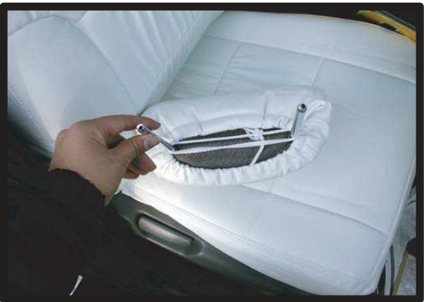
②ヒモをきつく縛り支柱にかけて結びます。
