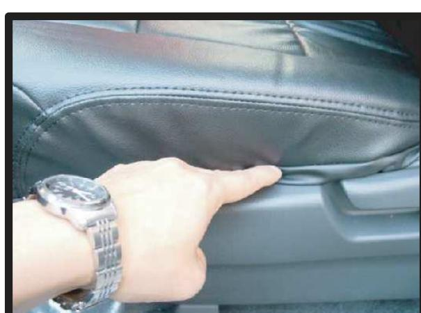
⑥助手席側はシートカバー横にスponジが巻いてあるので、座面の隙間に入れ込みます。シートカバー前後のベルトはシート下で固定します。
