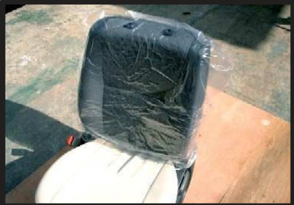
①背もたれカバーを取り付ける前に補助ビニールを被せます。補助ビニールは後で取り外すのでカッター等で両サイドに切込みを入れて取り外し易いようにしておきます。
