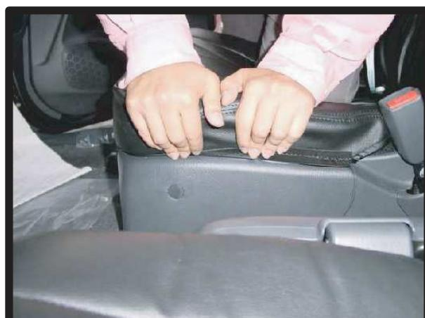
⑤シートカバー横に付いている黒いプラスチック部分を座面の隙間に入れ込みます。
