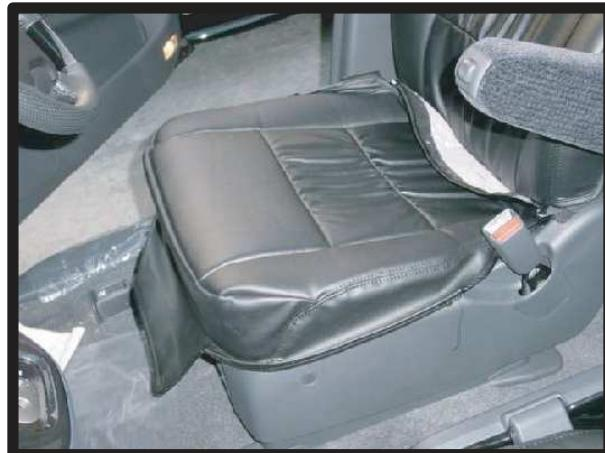
④運転席の座面カバーをシートのラインに合わせてかぶせます。前後のマジックテープをシートに固定します。
