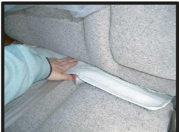
②背もたれと座面の間にカバーを取り付けます。中央のシートベルトをよけてマジックテープで固定します。
