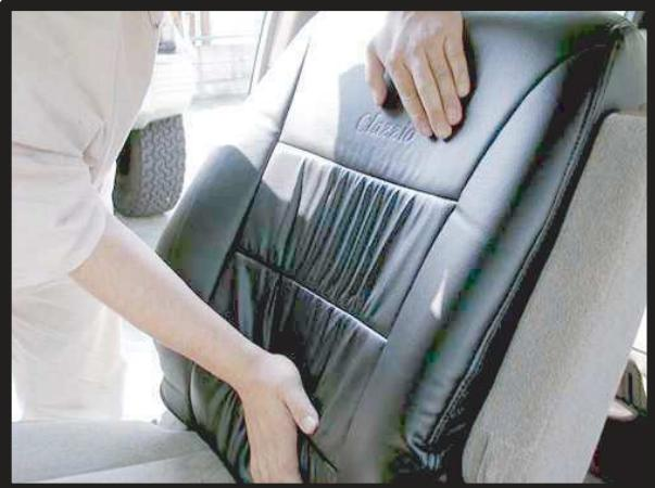
②側面のしわを中央に寄せるようにしてシートとカバーをなじませます。座面と背もたれの間にカバーを入れ込み、裏側から引き出します。
