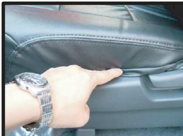
②ヒモの部分をプラスチックカバーの隙間にに入れ込みます。ヒモの先は背もたれと座面の隙間を通して、後ろにまわしておきます。
