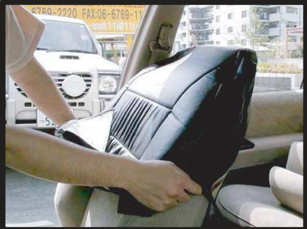
①ヘッドレストをはずし、背もたれカバーをかぶせます。マジックテープ部分を折り返して左右均等に引き下げていきます。
