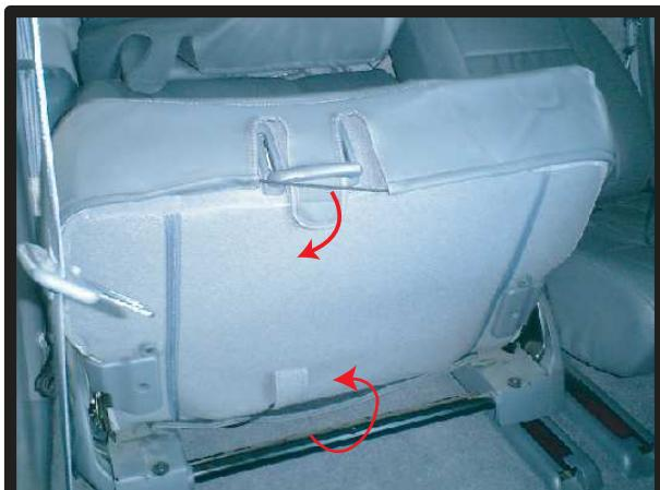
⑧⑥で隙間に入れ込んだマジックテープ部分を、座面裏側まで引き込み固定します。
