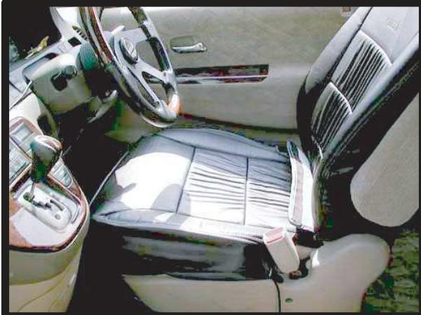
①座面カバーをシートのラインに合わせてかぶせます。座面と背もたれの間にシートカバーの後端を入れ込みます。
