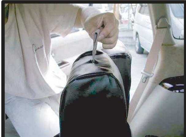
④先端のベルトを穴から取り出します。
