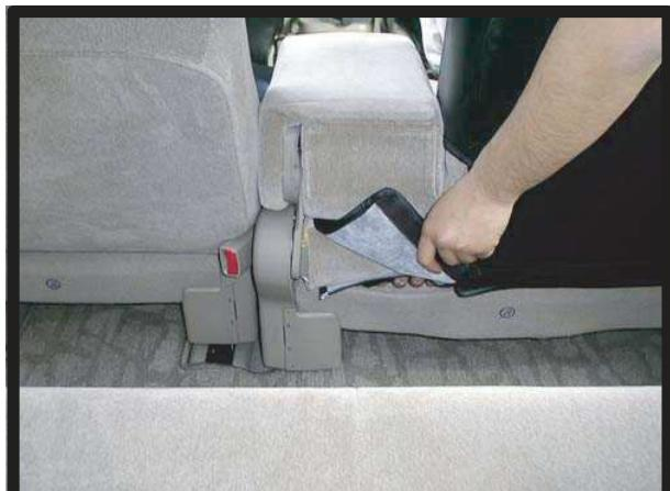
②アームレスト下部分のカバーを入れ込み、後ろ側でマジックテープを固定します。
