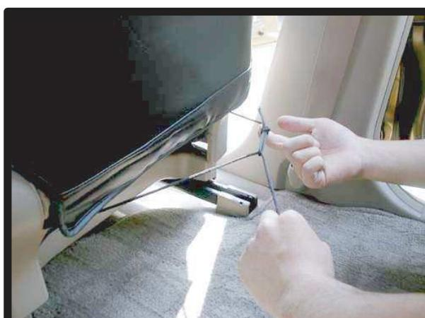
③座面後ろ側にヒモを取り出し、固定します。片側のヒモで輪を作り、反対側のヒモを通して絞り込んでから結びます。そしてマジックテープを座面後ろに固定します。
