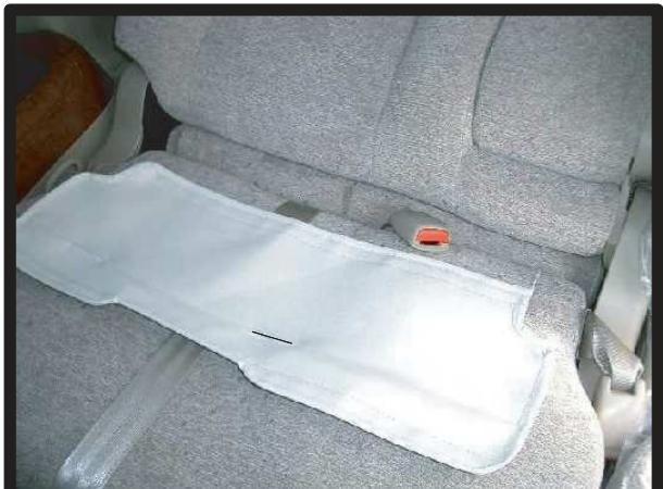
①シートカバーを図の向きに取り付けます。2つの穴はチャイルドシート用フックの位置になります。フックを使用される場合はフック部分のカバーを外してください。
