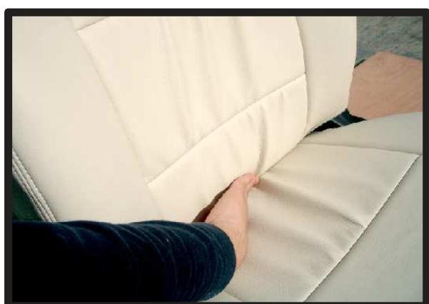
⑤背もたれの曲線にたるみなくカバーを密着させながらマジックテープ部を背面と座面の間にに入れ込みます。
