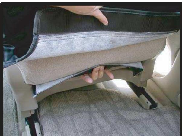
③裏側に引き出したマジックテープ部分を固定します。アームレスト下部のマジックテープも固定します。
