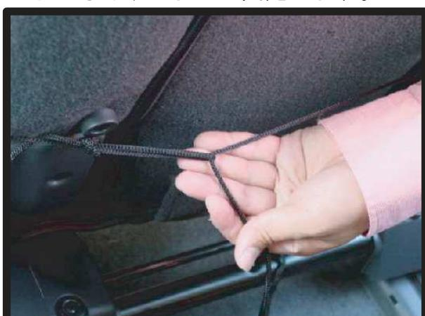
⑨座面裏側で、左右のヒモを固定します。片側のヒモで輪を作り、反対側のヒモを通して適度に絞り込んでから結びます。（引っ張り過ぎに注意して下さい。切れる恐れがあります。）
