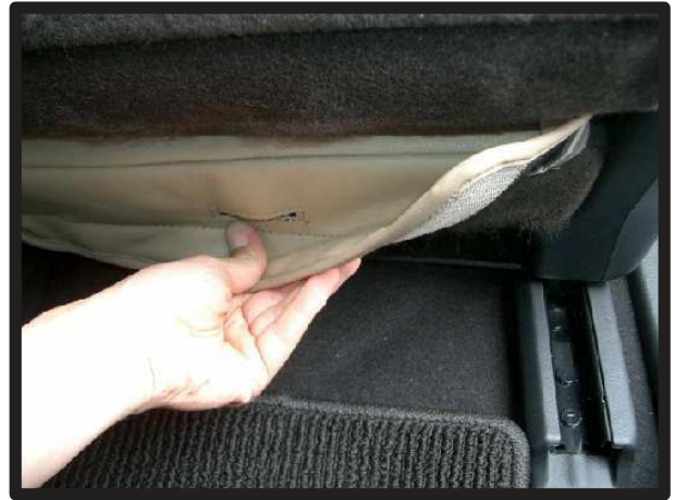
⑩④で引き出した生地をシート本体に貼り付け固定します。
