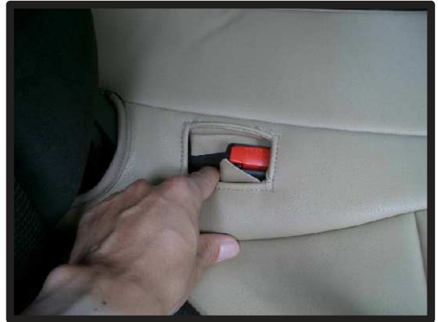
⑪シートベルトの留め具の穴に生地を入れ込みます。
