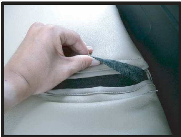
⑧背面のアジャスターを引き上げ、生地をマジックテープでシートに貼り付け固定します。
