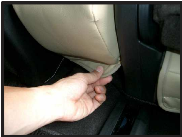
⑨アームレスト下部分の生地をシート本体に貼り付け固定します。
