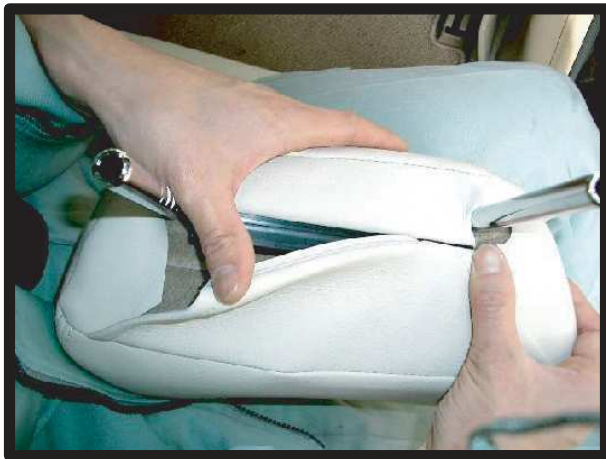
⑦端から押し込んでいきます。
