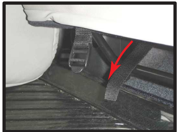
⑪シート下からベルトを取り出し、カバー前側で1列目と同様に固定します。※ベルトは図のようにシートスライドバーの上側を通して下さい。
