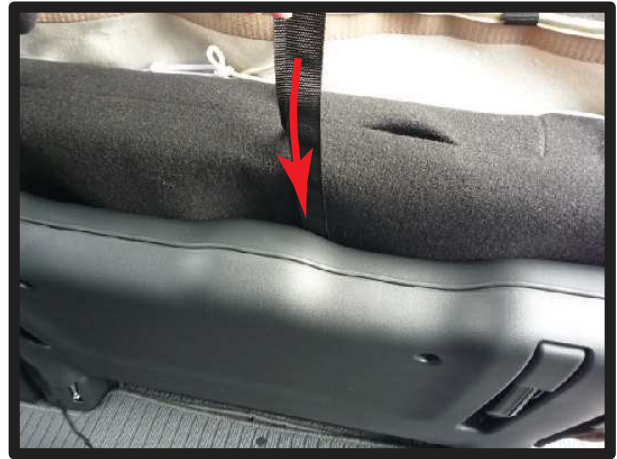
⑩7ページ②で入れ込んだ生地を引き出し、マジックテープでシートに直接固定します。シートの土台と本体の隙間にベルトを通します。
