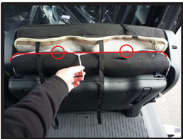
⑨シートを跳ね上げ、カバー側面に付いているヒモを、図の赤線のように沿わせ、カバー裏側に付いているループ状のガイド(図の○部)に通し、固定します。※固定方法は巻末のヒモの結び方を参照して下さい。
