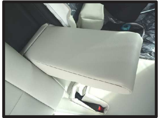
⑦タンブルシートの2列目センターアームレストは、カバーをかぶせてプラフックで固定します。
