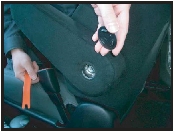
①アームレストの丸いプラスチックカバーをヘラなどを使い外します。
