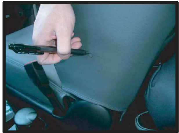
④アームレストを背もたれに戻せるようカバーに穴を開けます。 カバーがしっかり取り付け固定されている状態で始めて下さい。 まず差込口に印を付けます。
