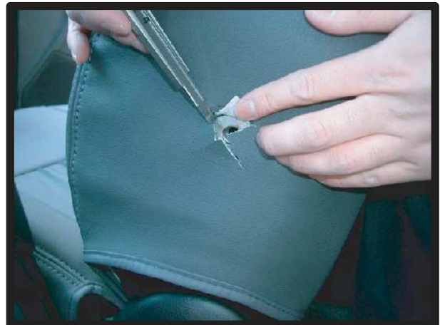
⑤印を目安にカッターなどを使い切れ目を入れます。
