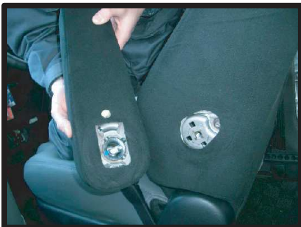
③ボルトを外すとアームレストが外れます。 この状態から背もたれカバーの取り付けを行なって下さい。
