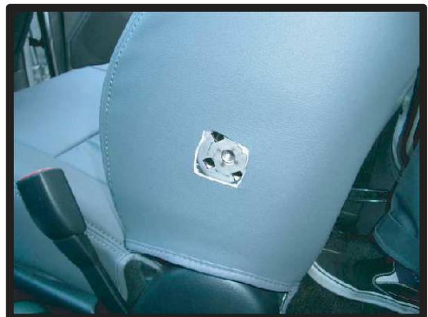
⑥切れ目の端を取り除き穴開け加工の完了です。 アームレストを戻した際、アームレストを前後させ生地がつっぱたりしてこないか確認して下さい。
