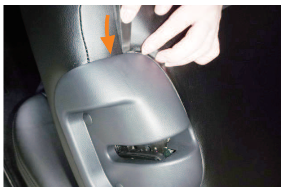
18 シート背面のヒンジ部の隙間に生地を入れ込みます。
