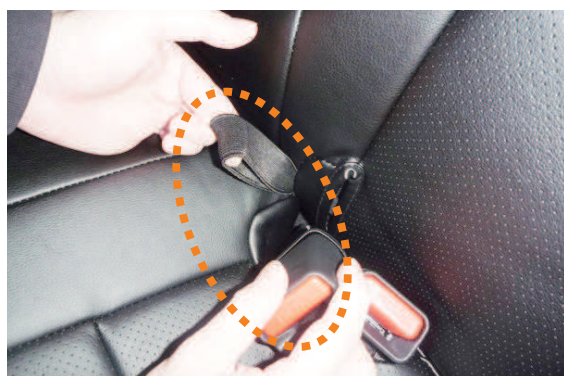
17 1番で外したシートベルトを、カバーに付いているゴムに取り付けます。
