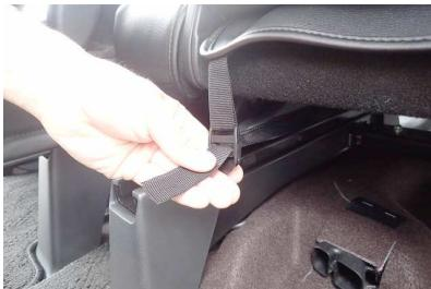
13 ⑩番で引き出した生地に付いているバックルに、引き出したベルトを通し固定します。
