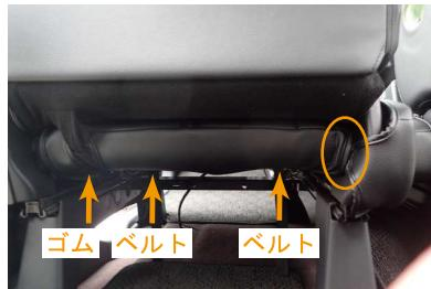
11 運転席座面と同様に、カバー前後のベルトとゴムを固定します。
