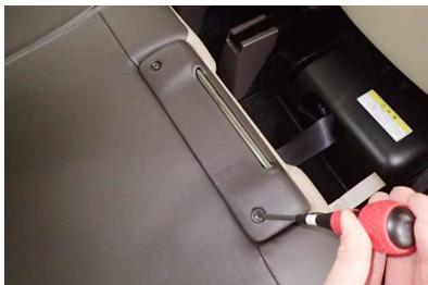
1 シート背面の上部にあるプラスチックカバーをドライバーを使用して外します。
