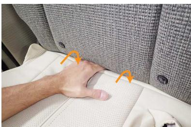
3 背もたれと座面の隙間にベルトの付いた生地を入れ込み、図のようにシートのフチを包み込むようにしてシート裏に通します。
