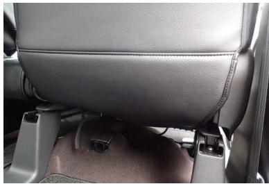
11 金属フックは、シート裏の金属部分に引っ掛けで固定します。
