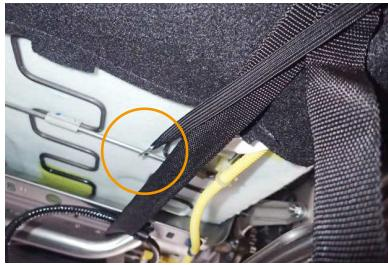
16 金属フックは、シート裏の金属部分に引っ掛けで固定します。
