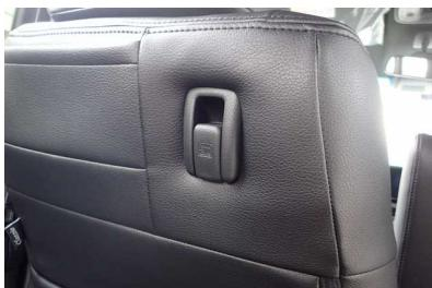
13 助手席背面のコンビニフックを使用する際は、カバー装着前にコンビニフックを取り外し、カバーに穴開け加工が必要になります。
