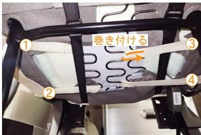
8 カバーの裏側に付いているマジックテープを、シート裏の金属部分に巻き付けるようにして固定します。
