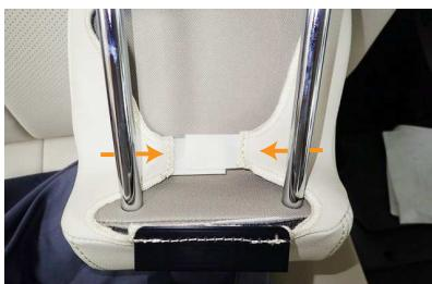
3 ヘッドレストをシートから取り外し、ヘッドレストの裏で左右のマジックテープ同士を固定します。
