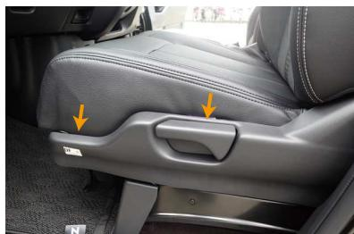
4 外側面の生地を、図の矢印位置にある固定具ごとプラスチックカバーとシートの隙間に入れ込みます。
