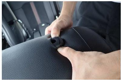
8 カバーの加工穴から、ヘッドレストの台座を取り出します。
