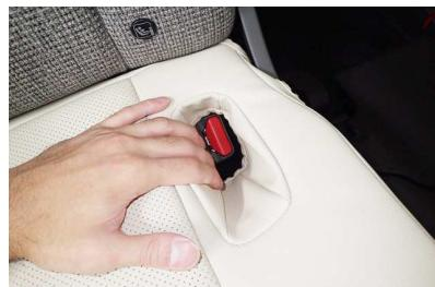
10 シートベルトバックル収納部分に生地を入れ込み、馴染ませます。
