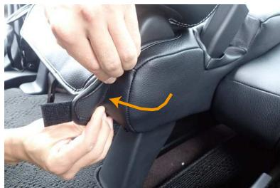
9 内側面のマジックテープの付いた生地を、シートの角に引っ掛けるようにしてかぶせます。
