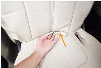
7 背もたれと座面の隙間に生地を入れ込みます。
