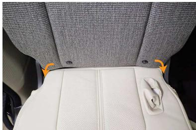
7 カバー付け根の生地を、シートとプラスチックの軸の隙間に入れ込みます。
