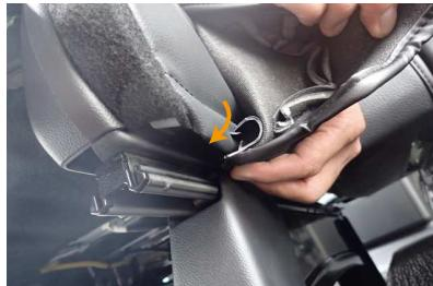
6 カバー内側面の生地に付いているプラスチックフックをシートのフチに固定します。詳しい固定方法は7番をご覧下さい。
