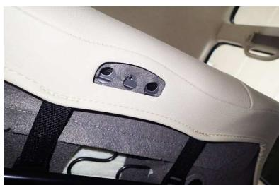
6 1番で外したプラスチックパーツ固定用の穴と、カバーの加工穴の位置が合っている事を確認して下さい。
