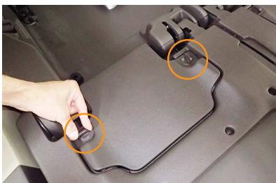
3 シート背面下部にあるプラスチックカバーを、図のように2箇所のつまみを回して外します。
