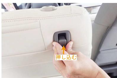
18 フレームに開いている穴に、ツメを差し込み、フックを強く押す事で元に戻すことができます。
