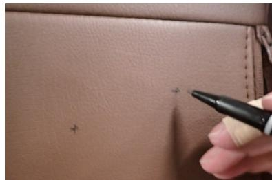
6 カバーの上から、ボルトと突起物が刺さる穴位置に穴開け加工用の目印を付けます。
