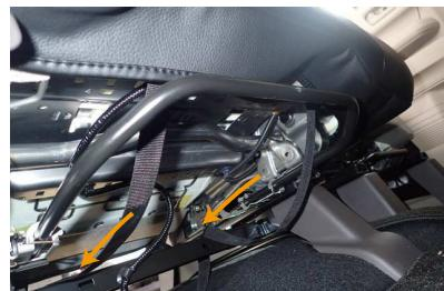
11 カバー前側に付いているベルトをシートの下側を通し、背面側に引き出します。
