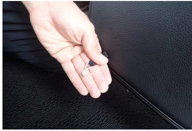
10 座面カバーと同様に、カバー背面下部の生地に付いているゴムに付属の金属フックを取り付けます。
