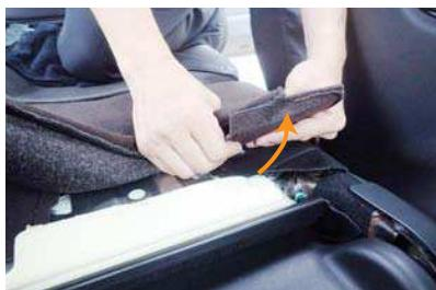
3 純正表皮がシートのフレームにピンで固定されている為、ピンを真上に引き抜き固定を外します。※ピンを破損させないように慎重に作業を行って下さい。図は手でピンを引き抜いていますが、内張りははがしなどで行うと作業がしやすくなります。
