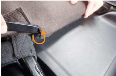
1 始めに、シート背面下部の純正表皮を固定しているプラスチックフックの固定を外します。図のように固定部分の隙間にへら等を差し込んでひねるようにすると、プラスチックフックが外れます。
