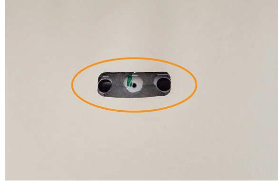
10 カバー背面の加工穴と、1番で外したプラスチックパーツの穴位置が合っている事を確認し、プラスチックパーツを元に戻します。
