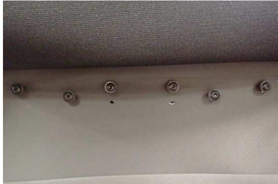
7 カバーの上から穴位置を探るのが難しい場合は、一旦ボルトを元に戻しておくと、穴位置が探しやすくなります。突起物の刺さる穴位置は、上側のボルト位置からの距離を測り、目安にして下さい。
