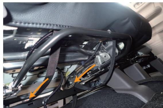
11 カバー前側に付いているベルトをシートの下側を通して、背面側に引き出します。
