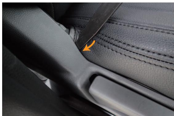
8 図の位置に生地を入れ込む際は、プラスチックカバーに対して矢印方向に生地を入れ込むようにします。
