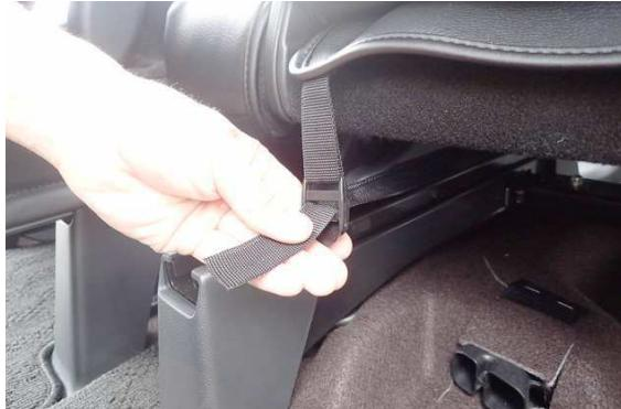
**13** 10番で引き出した生地に付いているバックルに、引き出したベルトを通し固定します。
