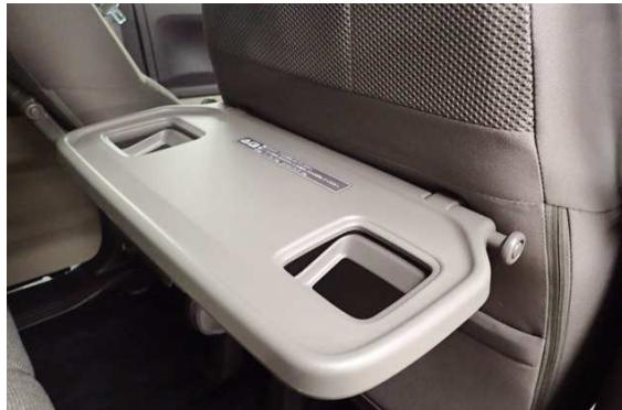
1 オプションのシートバックテーブル装着車は、カバー装着前にバックテーブルを取り外します。
