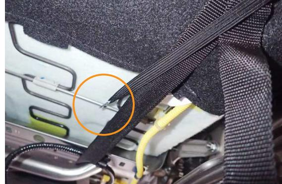
**16** 金属フックは、シート裏の金属部分に引っ掛けて固定します。
