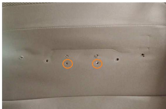
5 テーブルを固定していたボルト穴です。中央2ヶ所の○印の穴は、テーブル側に付いている突起状のパーツが刺さる穴になります。この状態で、シートカバーを装着します。
