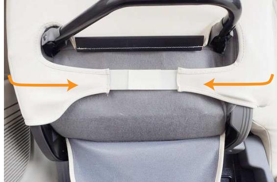
7 カバーの両側面に付いているマジックテープをシート裏で固定します。
