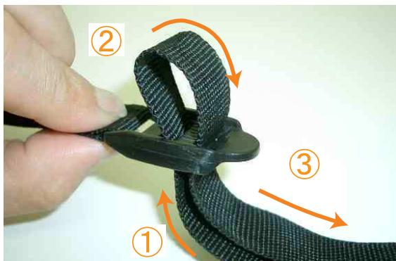
**14** ベルトの通し方は、図の①～③の順番にベルトをバックルに通し、引く事でベルトが締り固定されます。
