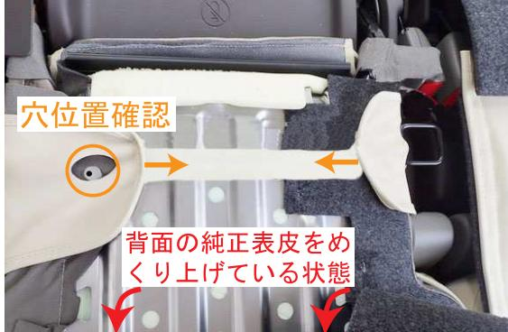
13 11番と12番で背面に回した生地に付いているマジックテープ同士を、背面の純正表皮をめくり上げた箇所で固定します。カバーに開いている加工穴と4番で外したピンの固定穴が合っている事を確認して下さい。
