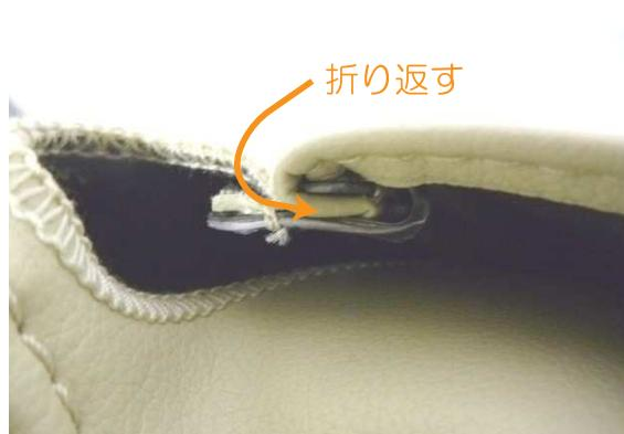
9 フックは力ギ状になっているプラスチックに板状のプラスチックを、生地と共に折り返して挟み込み固定します。
