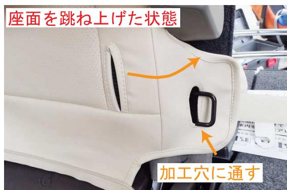
12 内側の生地も同様に背面側に回します。この時、5番で純正表皮が固定されていた金属部分を、カバーの加工穴に通して下さい。
