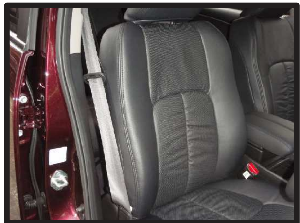
⑮1列目背もたれの完成です。助手席側も同様に取り付けます。
