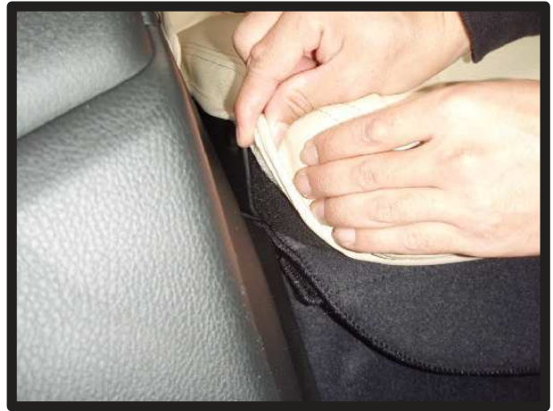
④カバー側面もシートにマジックテープで直接固定します。
