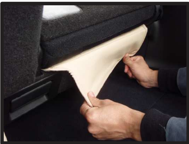
③シート背面から生地を引き出し、シートに引き出した生地をマジックテープで直接固定します。
