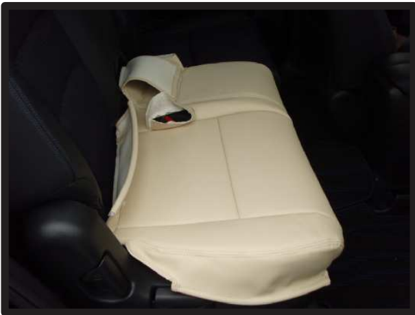
②シートのラインからずれないようにカバーをかぶせます。
