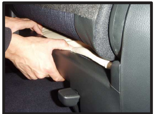
⑥引き出した生地をシート背面のプラスチック部分に入れ込みます。
