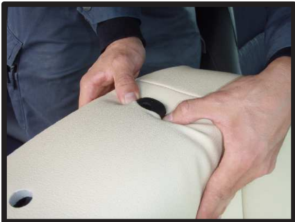
⑪ヘッドレストの台座を取り出します。台座の片側に生地をしっかりと潜り込ませます。
