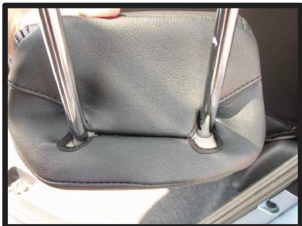
⑦カバーをかぶせ、1列目と同様にブラックを固定します。
