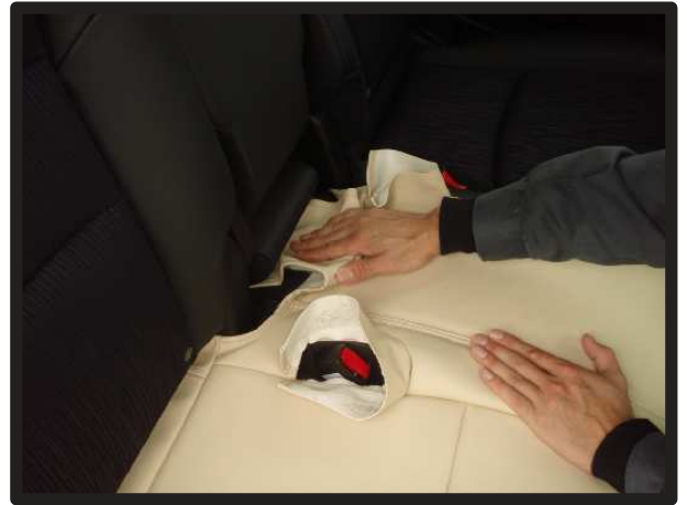
④アームレストの下にも生地を入れ込みます。
