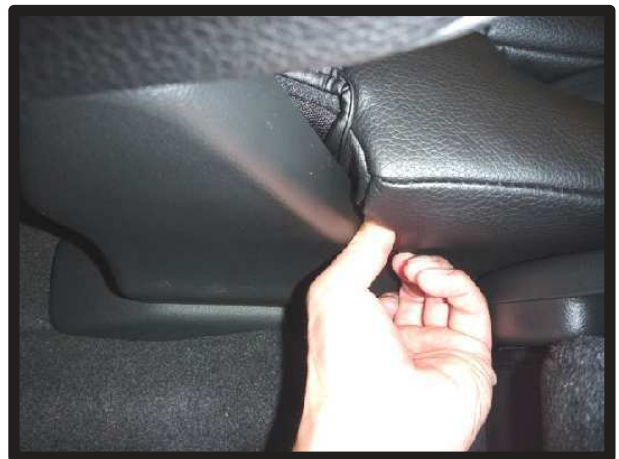
⑲助手席側も形状は違いますが、ほぼ運転席側と同様に固定します。カバーの内側面のみ固定方法が異なります。助手席側内側面の後部にゴムが付いています。ゴムはシートとプラスチック部の隙間に入れ込みます。
