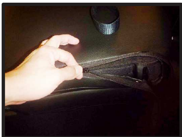
③入れ込んだ生地をシート背面から引き出します。引き出した生地とカバー背面下をファスナーで固定します。
