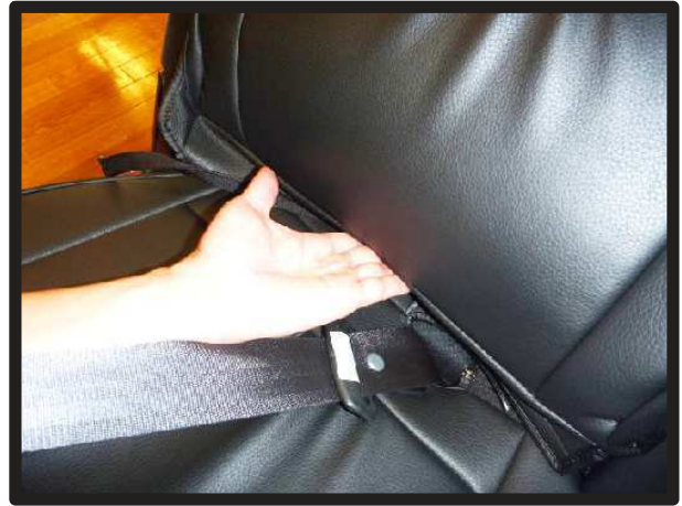
⑩背もたれと座面の隙間に生地を入れ込みます。
