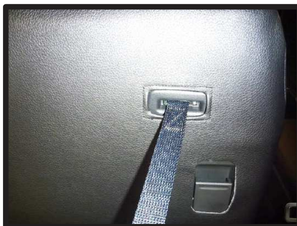
⑤シート背面のベルトをカバーの加工穴から出します。
