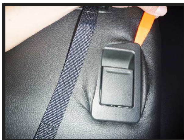
⑥シート背面のリクライニングレバーのフチに、ヘラなどを使用して生地を入れ込みます。
