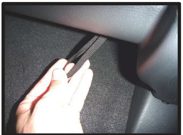
㉑入れ込んだゴムをシート裏から引き出して、S字フックを取り付けます。S字フックをシート裏の金属部分に引っかけて固定します。
