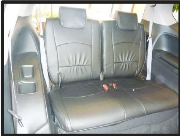
⑧カバーのラインを整えて、3列目運転席側背もたれの完成です。助手席側も同様に取り付けます。
