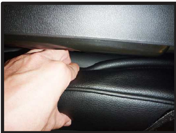
⑨カバー内側面の生地も、シートとプラスチック部の隙間に入れ込みます。
