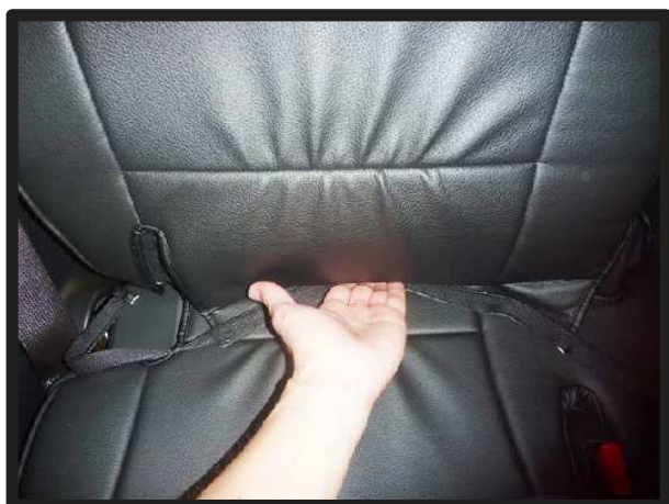
②背もたれと座面の隙間に生地を入れ込みます。
