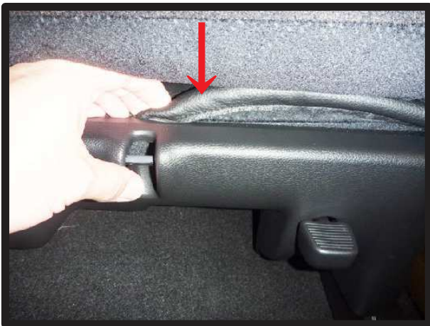
⑥シート背面から生地を引き出して、シートとプラスチック部の隙間に生地を入れ込みます。
