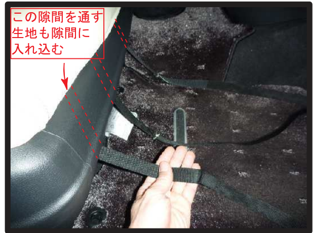
⑪パワーシートの場合は、シートとプラスチック部の隙間にベルトを通してシート裏から引き出します。それからシート裏を通してシート背面へ回します。
