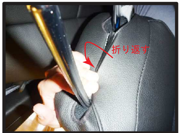
③ヘッドレストをシートから外します。ヘッドレストはヘッドレストの裏でプラフックで固定します。
