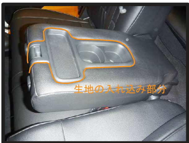
⑤図のドリンクホルダーなどのフチにヘラなどを使用して生地を入れ込みます。
