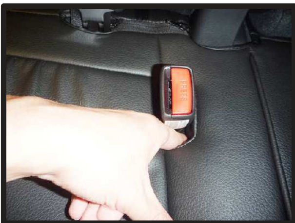
⑳シートベルトバックルのフチに生地を入れ込みます。
