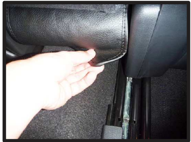
⑨シート背面から生地を引き出して、シートに直接貼り付けて固定します。
