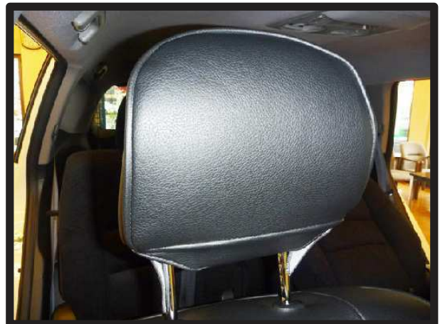
②カバーを左右均等に引き下げて、ヘッドレスト全体にカバーをかぶせます。
