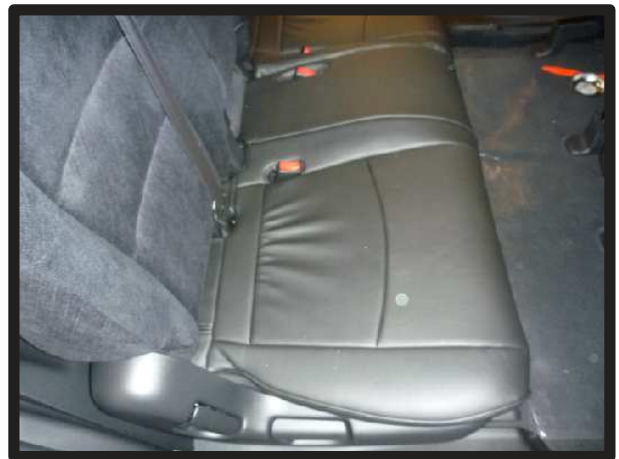
⑰カバーのラインを整えて、2列目運転席側座面の完成です。
