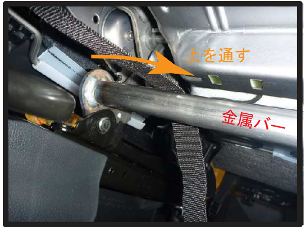
⑫手動シートのベルトはシートの裏を通す際に、図の金属バーの上を通すようにして下さい。
