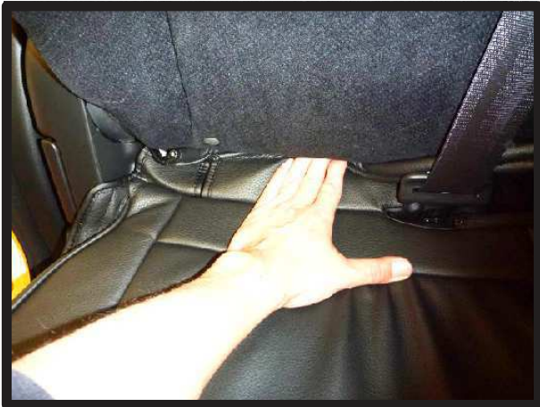
⑤背もたれと座面の隙間に生地を入れ込みます。
