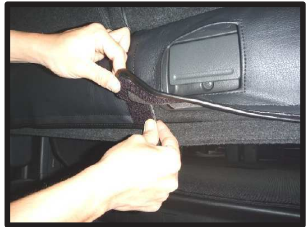
⑤引き出した生地の縦に付いているマジックテープでカバー同士を固定します。横に付いているマジックテープは、座面に直接固定します。
