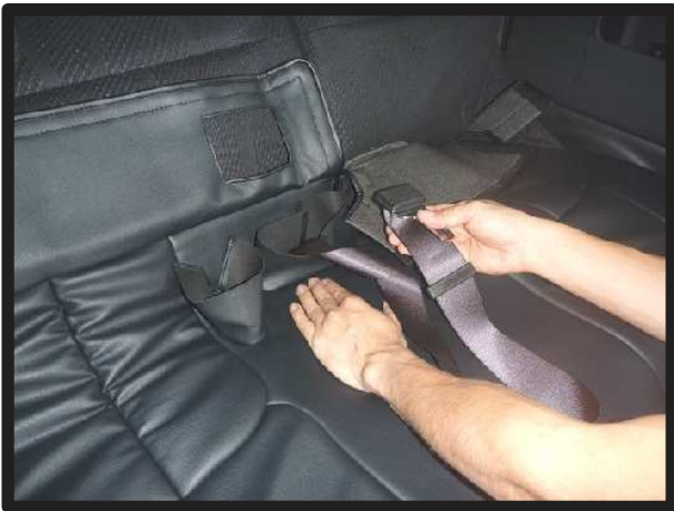
②カバーの加工穴から、シートベルトを取り出します。
