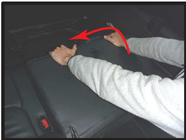
②背もたれをロックがかかるまで、前に倒します。カバーの厚みでロックがかかりにくくなっていますので、前に倒す際に、多少の反動をつけるとロックがかかりやすくなります。
