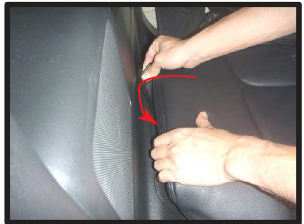
⑥側面の生地を矢印方向に巻きつけるようにし、マジックテープで座面下に固定します。
