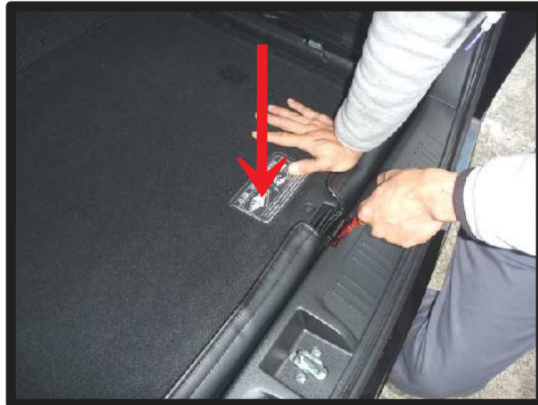
④床下格納後のロック部分は、カバーの厚みでシートが浮いてきますので図のようにシートを押さえながらロックを掛けます。
