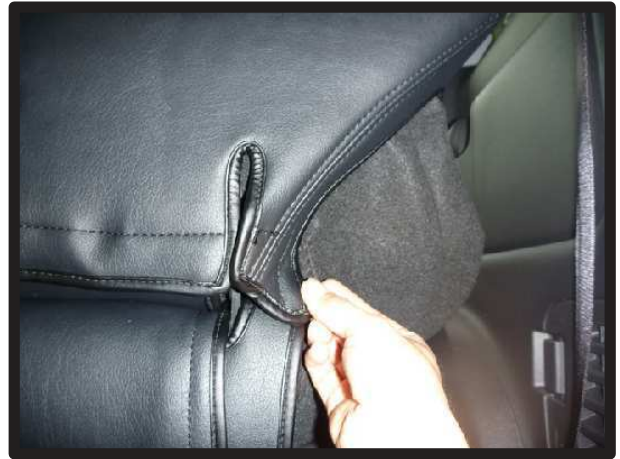
⑩側面の生地は、マジックテープで背もたれに直接固定します。
