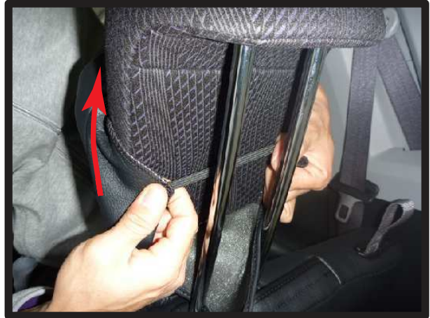
⑩ 3列目ヘッドレストは、上に上げた状態でカバーをかぶせます。図のようにカバーに付いているゴムがヘッドレストの裏側にくるようにして、下側からかぶせていきます。
