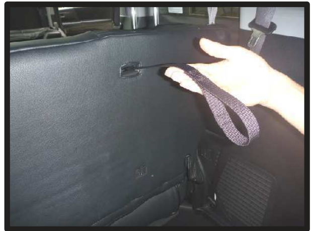
⑪運転席側背もたれの背面にあるストラップを、カバーの加工穴から取り出します。
