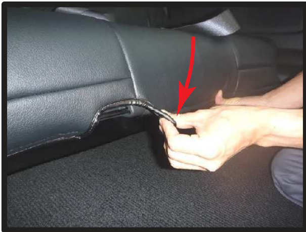
⑧前側の生地は、端から順番にマジックテープで座面下に固定していきます。
