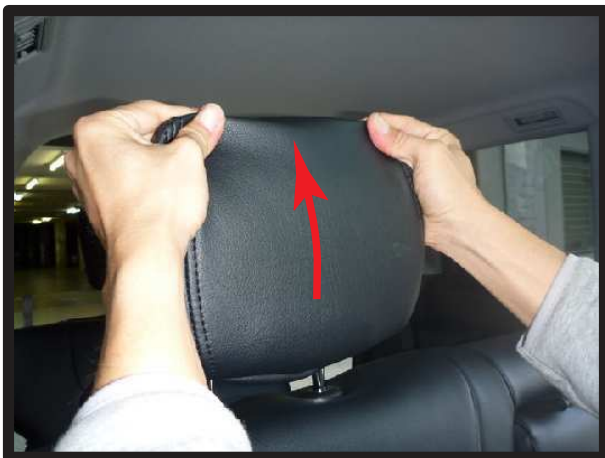
⑧ ラインを合わせながら、矢印方向にカバーをかぶせていきます。
