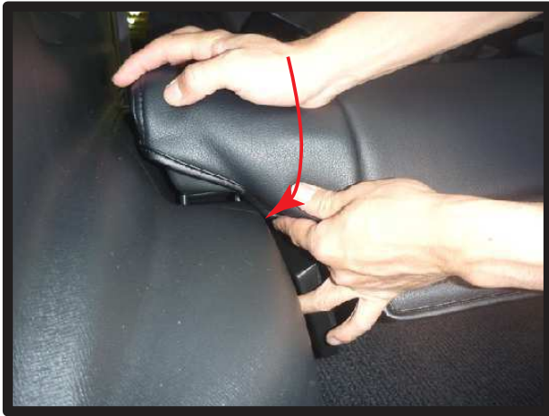
⑦前側の生地を、図のように座面のラインに合わせて、マジックテープで座面下に固定します。
