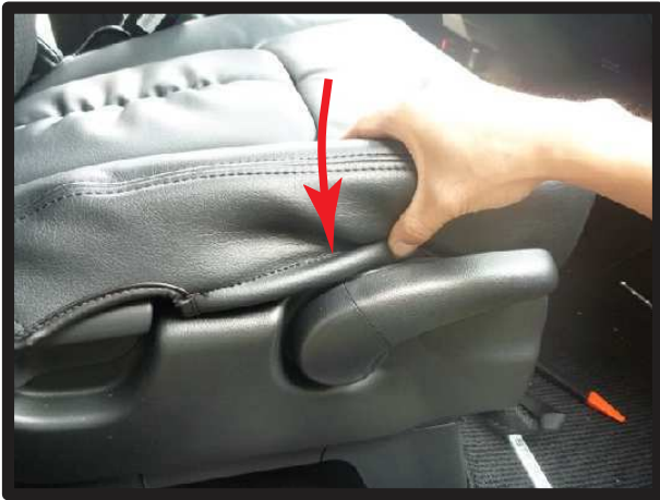
⑦側面の生地は、座面のプラスチック部の隙間に入れ込みます。
