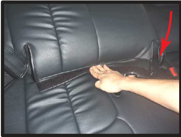
⑦背もたれと座面の隙間に生地を入れ込みます。 矢印部の生地を入れ込む際は、隙間が大変狭いので、ヘラ等を使用し生地を押し込みます。
