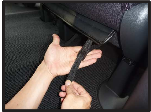
⑩ベルトを座面後ろ側で固定します。
