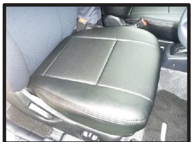
⑪カバーのラインを整えて1列目運転席座面の完成です。助手席座面は両側面のみ固定方法が異なります。詳しくは次の⑫をご覧ください。
