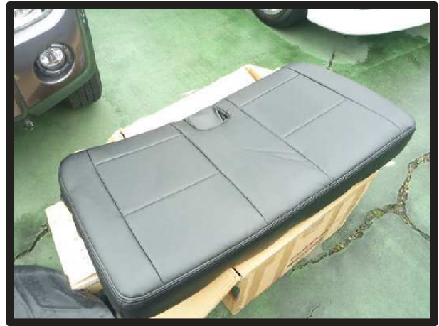
⑪カバーのラインを整えて2列目座面の完成です。 ※2列目背もたれのカバーを取り付け後にシートを車体に戻します。
