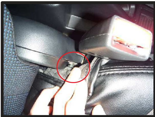
⑧内側面も同じ様に図の○部分へヒモの先を落とし込みます。
