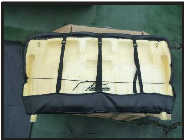
⑨ヒモを結びます。 ※詳しい固定方法は巻末の「ヒモの結び方」をご覧ください。
