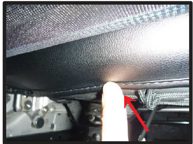
⑩ヒモの結び目は1ページ④で引き出した生地裏側へ入れ込みます。
