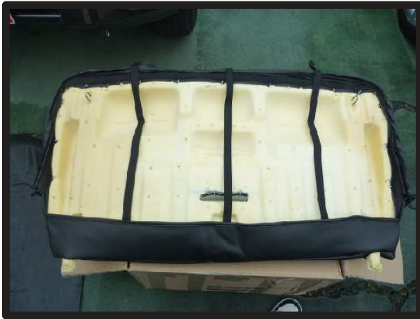
⑧シートを再び裏返し、ベルトを固定します。 ※詳しい固定方法は巻末の「ベルトの通し方」をご覧ください。
