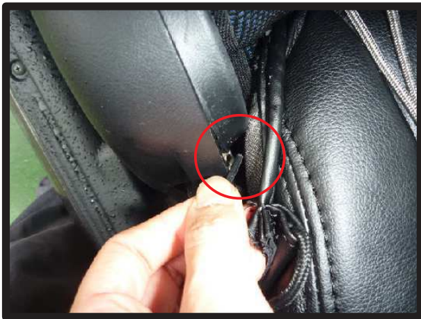
⑦運転席座面は外側面に付いているヒモの先を○で示した隙間へ落とし込みます。
