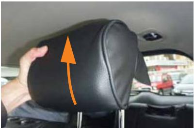
7 2列目のヘッドレストです。2列目ヘッドレストは図の矢印方向に、ヘッドレストのラインに合わせて下から上へかぶせます。カバーは平らなプラスチックが付いている方が前です。
