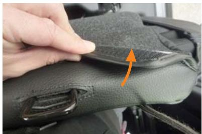
8 シート後ろ側の裏です。こちらは直接シートにマジックテープを貼り付けて固定します。
