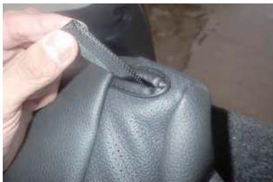
1 始めにリクライニング用のベルトをカバーの加工穴から取り出します。
