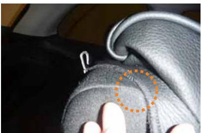
8 2列目ヘッドレストの後ろ側にカバーをかぶせていく際は、図の丸印部分に負荷がかかりやすいので、しっかり生地を馴染ませながら慎重にかぶせて下さい。
