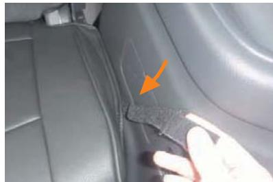
5 カバー側面に付いているマジックテープのベルトをシート裏に回します。
