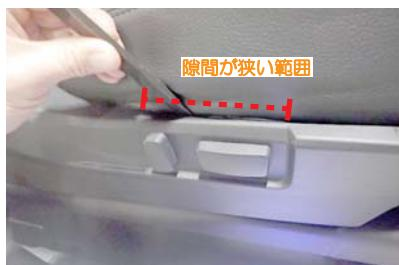
12 パワーシート車はスイッチ部分の隙間が大変狭いため、シートカバーのスイッチ部分の上には固定部材を付けていません。前後は**11番**同様に固定部材を入れ込み、スイッチの上部分は生地のみを隙間に入れ込んで下さい。
