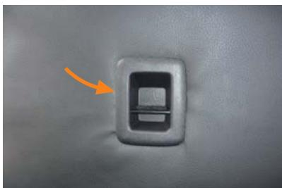
17 シート背面のチャイルドシート固定用アンカーのフチに生地を入れ込みます。隙間が大変狭いため、ヘラなどを使用して慎重に行って下さい。
