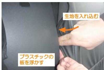
12 アームレストを倒して、アームレスト収納部に生地を入れ込みます。収納部にあるプラスチックの板を反るようにして少し浮かしながら、生地にシワがよらないように入れ込んでいきます。板を破損させないように作業は慎重に行って下さい。
