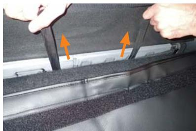
6 PHEVは2列目シート背面とラゲッジスペースの隙間が大変狭いため、生地の端に図の用なベルトを付けています。まずベルトを引き出し、ベルトを慎重に引っ張りながら生地の端がつかめるまで引き出します。生地の端がつかめたら生地を引っ張り引き出します。ベルトはあくまで生地を引き出すサポートの役割です。強く引っ張りすぎるとすぐに切れる恐れがありますので、ご注意下さい。
