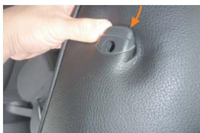
3 ヘッドレストの台座を取り出します。まず台座の片側のフチに生地をしっかりと入れ込みます。
