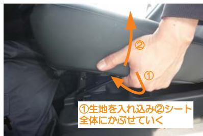
12 運転席側座面は、始めにシート内側面のシート裏の隙間に、マジックテープの付いた生地を入れ込み、シート全体にカバーをかぶせます。その他は一部形状は異なりますが、助手席側同様に取り付けます。
