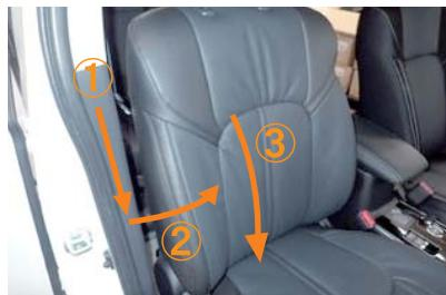
7 カバー側面の生地を、図の①～③の順番でシートに密着させるようにして、シワをなくしていきます。側面の生地がしっかりと張るまで繰り返し行って下さい。
