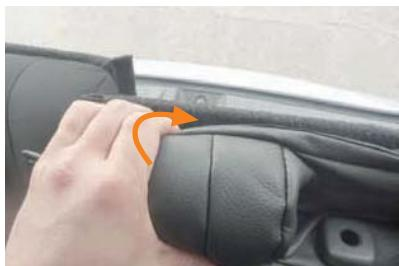
3 カバー上側のマジックテープの付いた生地を、シートと背面のバックボードの隙間に巻き込むように入れ込みます。マジックテープをバックボード側に直接貼り付けて固定します。
