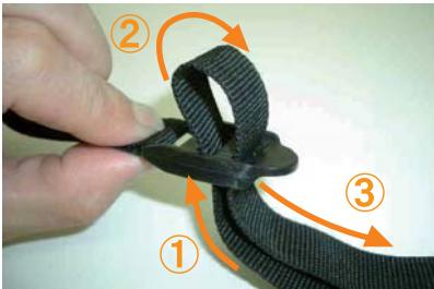
19 ベルトは①→②→③の手順で、まずバックル中央に通し、折り返してバックルの端に通します。通したベルトを引くとカバーの前後を引き絞り固定されます。ベルトは強く引くと縫製糸が切れて、ベルトが抜けてしまう恐れがあるのでご注意下さい。
