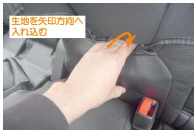
11 アームレスト下の隙間から生地を入れ込み 中にあるくぼみに、生地の端に巻いてある 部材を、はめ込むように固定します。
