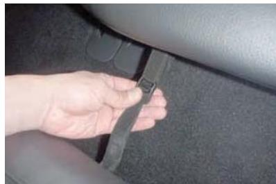
4 ベルトはカバー前側に付いているバックルに通して固定します。
