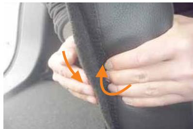
4 カバー側面のマジックテープの付いた生地端を、シートとバックボードの隙間に巻き込むように入れ込みます。バックボード側のフチの生地をマジックテープ側に貼り付けにいくようにして固定します。
