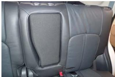
18 PHEVは14ページ1番で外した生地を、シートカバーの背面下に付いているマジックテープに貼り付けて固定します。
