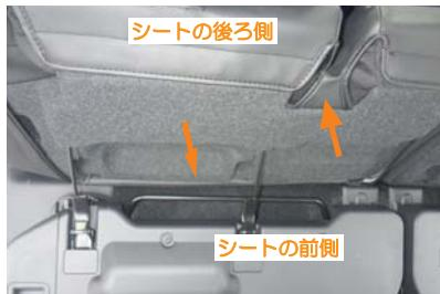
10 シート裏の図です。マジックテープを直接シートに貼り付ける部分と、隙間に入れ込む部分で別れています(矢印位置)。隙間に入れ込むマジックテープはシート地には貼り付きません。
