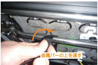
15 シート前側からシート裏を見た図です。カバー前方に付いているベルトを図の金属バーの上を通してシート背面へ回します。図は手動シート車です。パワーシート車は15番を確認して下さい。
