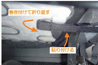
6 マジックテープのベルトは、シート裏の金属部分に巻き付けて折り返し、貼り付けて固定します。
