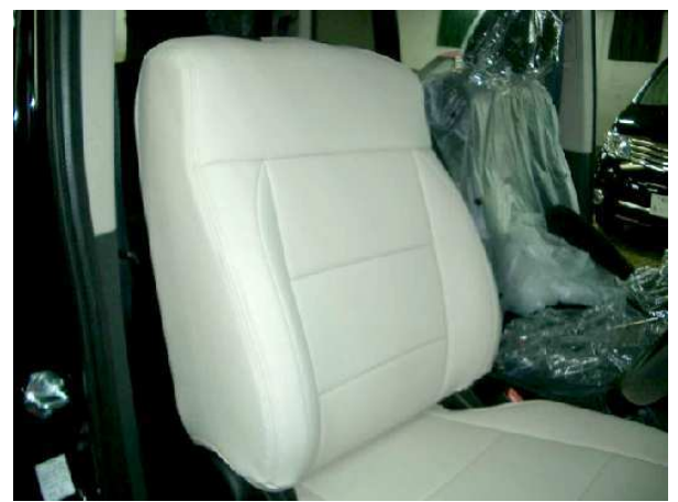
⑫シートのラインを整えて1列目背もたれの完成です。助手席側も同様に取り付けます。
