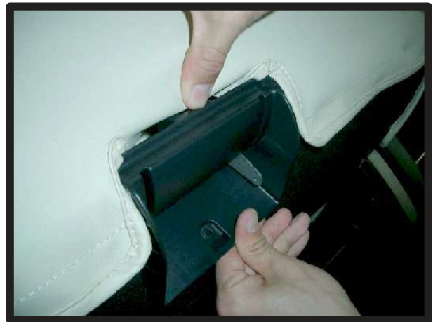
⑩スライドレバー部の生地を挟み込んで、外した逆の手順でスライドレバーを戻していきます。
