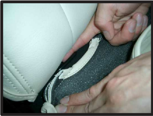
⑤シートベルトを取り出した生地は背もたれ下に入れ込み、マジックテープでシート本体に固定します。チャイルドシート固定用フックに穴位置を合わせ、背もたれと座面の隙間に生地を入れ込みます。
