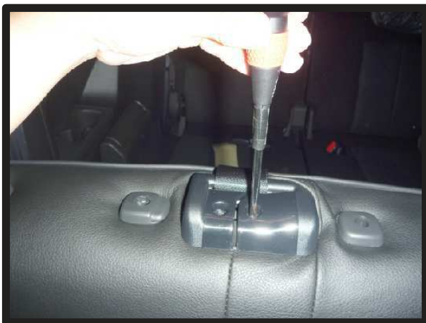
⑨中央のシートベルトが出ているプラスチック部のネジを2本外します。
