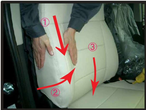
⑧①～③の順番にカバーをなで下ろして、シートに馴染ませるようにシワを無くしていきます。
