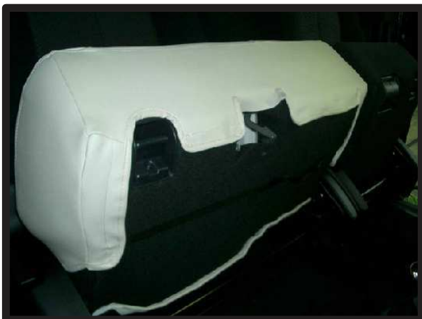
⑨カバーをマジックテープで固定していきます。 スライドレバー部のみ、生地が浮いている状態になります。
