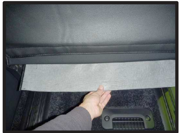
⑱入れ込んだ生地を、背もたれ裏側から引き出します。
