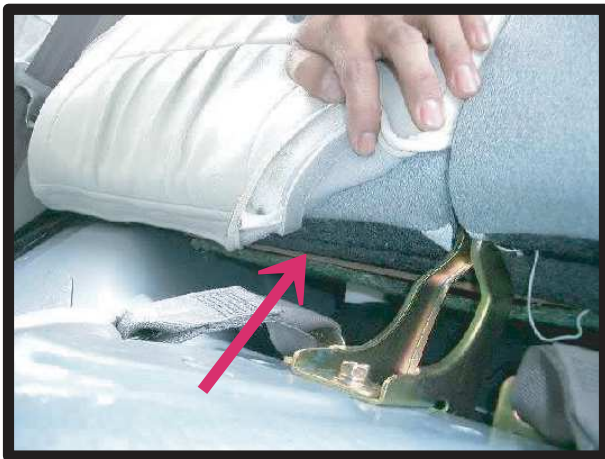
③背もたれカバーをしっかりと密着させ、図の位置にマジックテープで固定します。背面も同様にシート本体にマジックテープで固定します。
