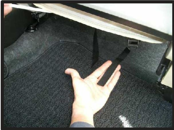
⑧ベルトをシートスライドバーの内側を通るように、背面に通します。
