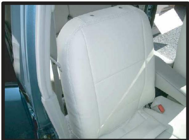
②ヘッドレスト台座の穴とカバーの穴位置を合わせ、側面をなでるようにしてシート本体に馴染ませます。
