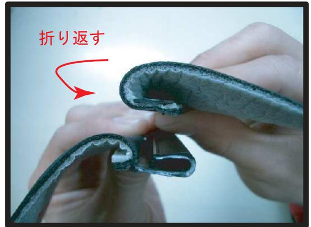
④平らなプラスチックの付いた部分を内側へ巻き込むように折り返し、カギ状のプラスチックの溝に押し込んでいきます。
