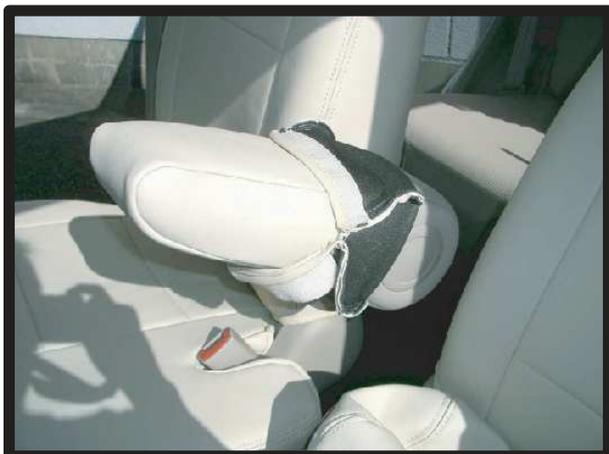
① 1 列目アームレストカバーをかぶせます。マジックテープ部分を折り返して左右均等にかぶせていきます。先端にたるみが出来ないように、しっかりかぶせて下さい。
