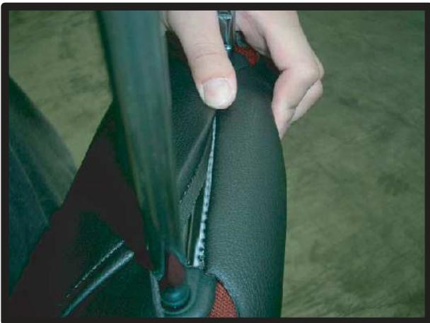
③ヘッドレストを背もたれから取り外し、底面のカバーをかぶせます。
