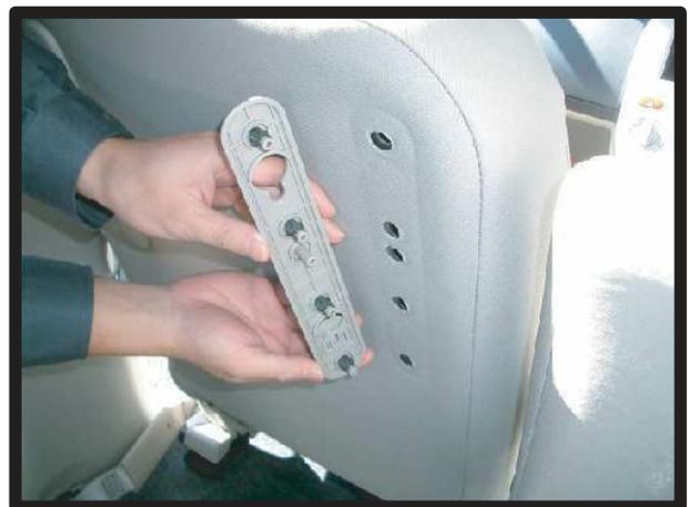
⑫2箇所取りはずし、運転席側と同様にカバーを取り付け、最後にマルチポジションユーティリティを元に戻し、助手席背もたれの完成です。
