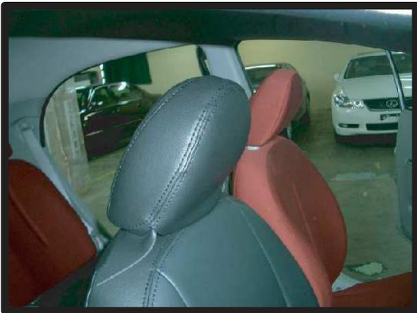
②カバーをかぶせ、カバーをヘッドレストに馴染ませるようにしながら、位置を合わせます。
