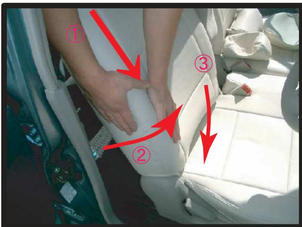
⑨①～③の順番にカバーをなで下ろしてシートに密着させるようにしわをなくしていきます。
