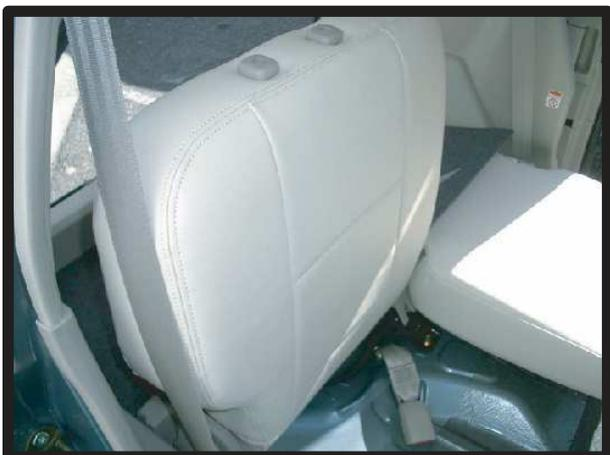
⑨シートのラインがずれていないか確認して2列目背もたれの完成です。助手席後部側も同様に取り付けます。
