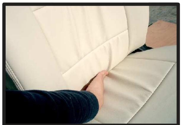
⑤背もたれの曲線にたるみなくカバーを密着させながらマジックテープ部を背面と座面の間に入れ込みます。
