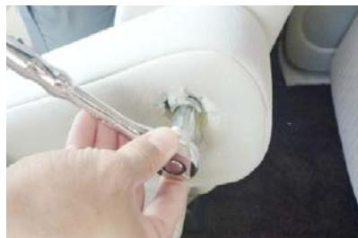
② ソケットレンチなどを使用して、中のボルトを外します(ソケット14mm)。
