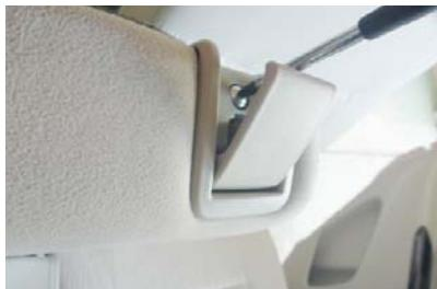
1 シートの肩口に付いているリクライニングレバーのネジを、ドライバーを使用して外します。
