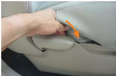
32 カバー外側面の生地を、シートとプラスチック部分の隙間に入れ込みます。
