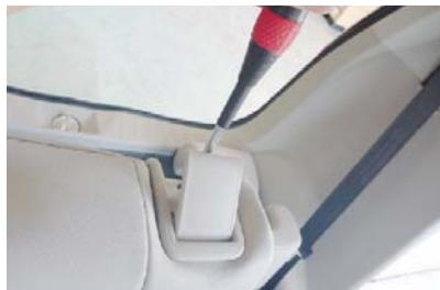
4 始めにネジを外したリクライニングレバーを、レバーのフチに生地を挟み込み固定します。
