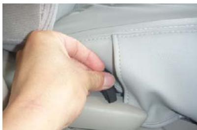
27 リクライニングレバーの先端付近のカバーに付いているゴムを、シートとプラスチック部の隙間に入れ込み、S字フックでシート裏に固定します。
