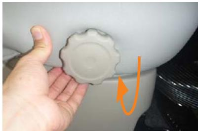
26 シートリッパーのダイヤル下の隙間に、生地をシートに巻き込むようにしてかぶせます。
