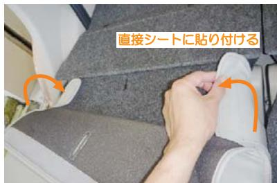
6 カバー側面下のマジックテープの付いた生地を、シートの背面へ引き出して、直接シートに貼り付けて固定します。
