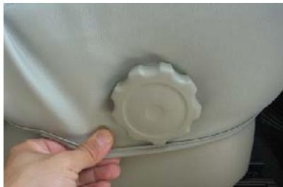
13 生地の伸びを利用して、シートリフターのダイヤルを加工穴から慎重に取り出します。
