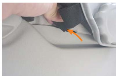
23 シートリフターのダイヤルがあるすぐ後ろ側のカバーに、幅の広いゴムが付いています。ゴムをシートとプラスチックカバーの隙間に入れ込みます。
