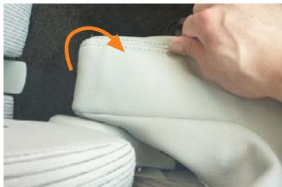
8 カバーを装着していきます。この際シートはシートリフターで一番高い位置に合わせておきます。図はシート内側面の後ろ側です。シート裏から引っ掛けるようにしてカバーをかぶせます。
