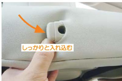
5 ヘッドレストの台座を取り出します。まず台座の片側のフチに生地をしっかりと入れ込みます。
