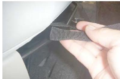
17 カバーの前側に付いているベルトをシート裏を通して、シート背面へ回します。
