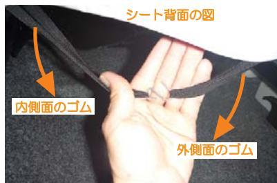
30 シートの付け根に付いているカバーのゴムは(内外両方)、シート裏へ引き出してS字フックでゴム同士を固定します。
