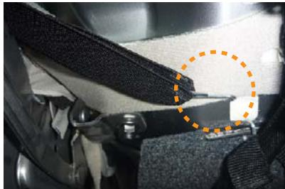
25 S字フックをシート裏の金属部分の溝に引っ掛けで固定します。
