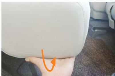
8 ヒモを縛り込む際に、カバーの下回りはシートの内へ巻き込む様にします。
