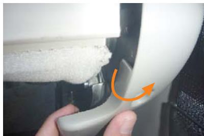
6 プラスチックカバーは、後ろ側から外します。矢印の方向へプラスチックを少し反らせながら、後ろ側の掛けりを外します。
