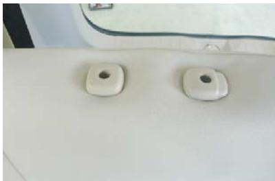
3 ヘッドレストの台座をカバーの加工穴から取り出します。
