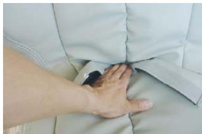
7 背もたれと座面の隙間に生地を入れ込み、シート背面から引き出します。
