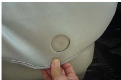
11 シートリフターのダイヤル部分にカバーの加工穴の位置があつていているかどうかを確認します。穴位置がずれている場合は、カバーがシートからずれていますと思われますので、8番からのカバーの装着を再度見直して下さい。
