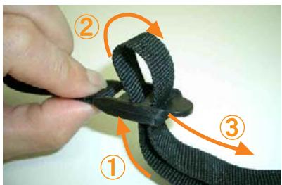
21 ベルトは①→②→③の手順で、まずバックル中央に通し、折り返してバックルの端に通します。通したベルトを引くとカバーの前後を引き絞り固定されます。ベルトは強く引きすぎると、縫製糸が切れでベルトが抜けてしまう恐れがありますので、ご注意下さい。
