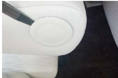
① 運転席側はアームレストを外します。始めに図のフラキャップをヘラなどを使用して外します。
