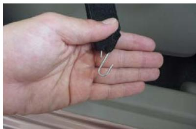
24 入れ込んだゴムをシート裏から引き出して、付属のS字フックを取り付けます。※図は分かりやすいようにシートの表側で画像を撮っています。
