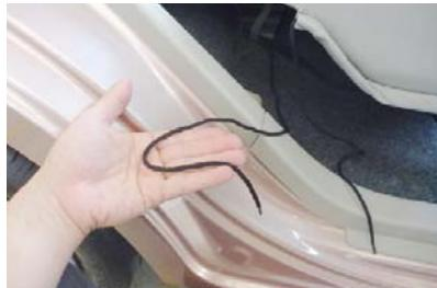
4 カバーの両側面からヒモがでています。内側面から出ているヒモを、シート裏を通してシートの外側へ引き出します。
