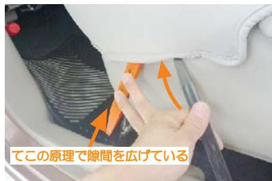
5 カバー外側面の生地を、シートとプラスチックカバーの隙間に入れ込みます。こちらは隙間が大変狭くなっています。図の様に生地を入れ込むへらとは別に、フチを広げる棒のようなものを差し込むなどすると、作業が行いやすくなります。
