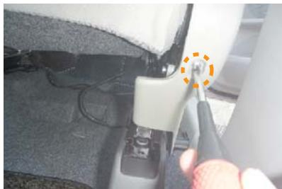
3 シート背面の図です。図の位置にあるネジをドライバーを使用して外します。
