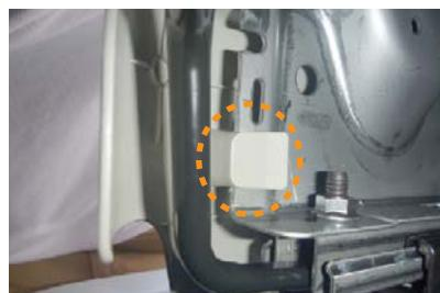
5 シート前側のシート裏外側面です。図の位置にフックが掛かっているのを確認して下さい。24ページ8番の作業でこのフックの掛けりを外します。
