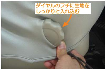
12 シートリフターのダイヤルにカバーの加工穴を通します。まず図の様にダイヤルの片側のフチに生地をしっかりと入れ込みます。
