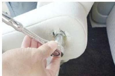
② ラチェットレンチなどを使用して、中のボルトを外します(ソケット14mm)。
