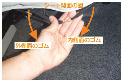
11 シートの付け根に付いているゴムは(内外両方)、シート裏へ引き出してS字フックでゴム同士を固定します。
