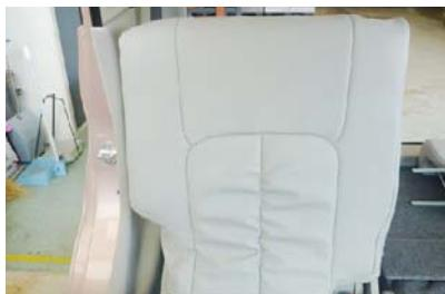
2 カバー側面のファスナーを開けた状態にして、シートのラインに合わせてカバーをかぶせます。
