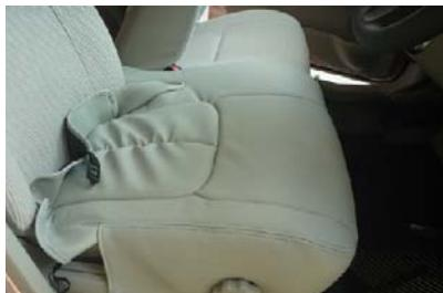
14 シート全体にカバーをかぶせて、再度シートのラインからカバーがずれていないか確認して下さい。
