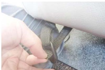
9 シートの裏から16ページ2番で前側に回したベルトを引き出して、カバー前側のバッ クルに通して固定します。
