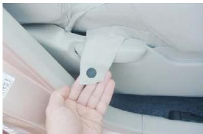
7 生地を完全に外した図です。図はピンが付いた状態ですが、ピンが生地から外れている場合は、シート裏へ落ちている場合があります。床に落ちていない場合はプラスチックカバーの中で引っかかっているので軽くプラスチックカバーを揺らすとシートの下から出てきます。
