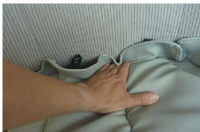
15 背もたれと座面の隙間に生地を入れ込みます。この際、一番上まで上げていたシートを、シートリフターで下げるごとに生地が入れ込みやすくなります。シートを下げた場合は生地を入れ込んだら元に戻して下さい。
