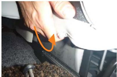
9 カバー内側面に付いている大きなプラフックを生地と一緒に折り返して、シートのフチにはめ込み固定します。
