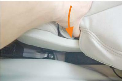
3 シート外側面の付け根の隙間に生地を入れ込みます。
