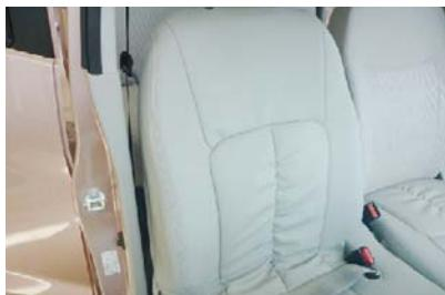
4 カバー側面のファスナーを開けた状態にして、シートのラインに合わせてカバーをかぶせます。
