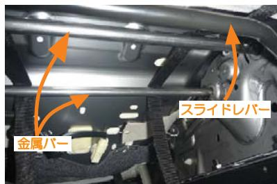
18 ベルトはスライドレバー、シート裏の金属バーの上を通してシート背面へ回します。
