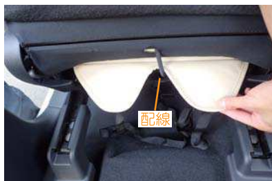
24 入れ込んだ生地を、背面側から引き出します。 配線が通っている場合、カバーのくぼみで配線をかわすようにして下さい。
