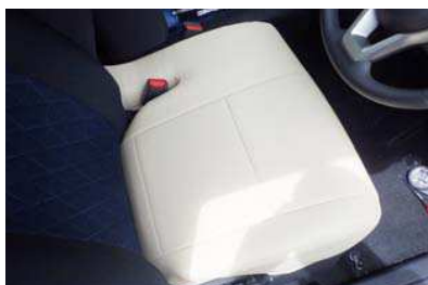
20 7ページ17番で外したレバーを元に戻しカバーのラインを整えます。 1列目運転席座面の完成です。
