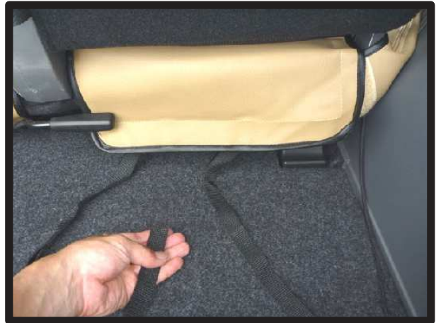
⑦⑤で引き出した生地に付いているベルトを、シート裏を通して前方へ回します。
