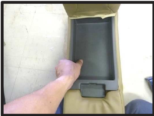
⑫ボックスを元に戻します。生地が中に入り込むので、多少突っ張る感じがします。ボックス裏のクリップの位置を意識しながら押し込みます。
