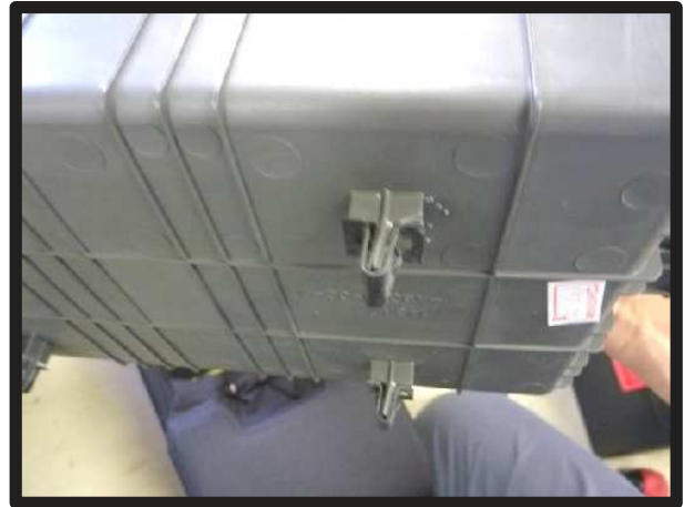
②ボックスは図のクリップではめ込まれています。プラスチックのツメなどに比べて壊れにくいですが、作業は慎重に行ってください。
