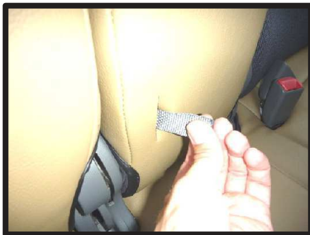
④アームレスト付け根のベルトをカバーの加工穴から取り出します。
