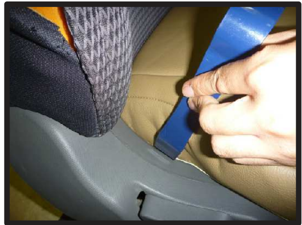
⑪シート側面の付け根部分の生地を、ヘラなどを使用してシワを伸ばしながらプラスチック部の隙間に入れ込みます。
