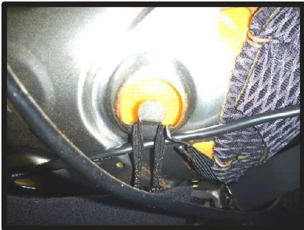
⑧S字フックをシート裏に引っ掛けて固定します。
