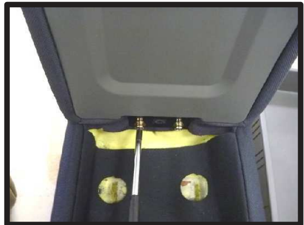
③ボックスを外すとフタを固定しているネジが2本あります。ネジをドライバーを使用して外し、フタをボックスから外します。
