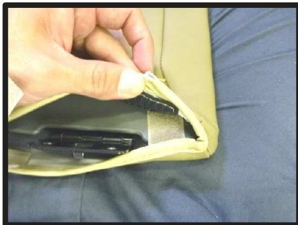
⑥カバーに付いているマジックテープを引き出して、フタの付け根部分で固定します。
