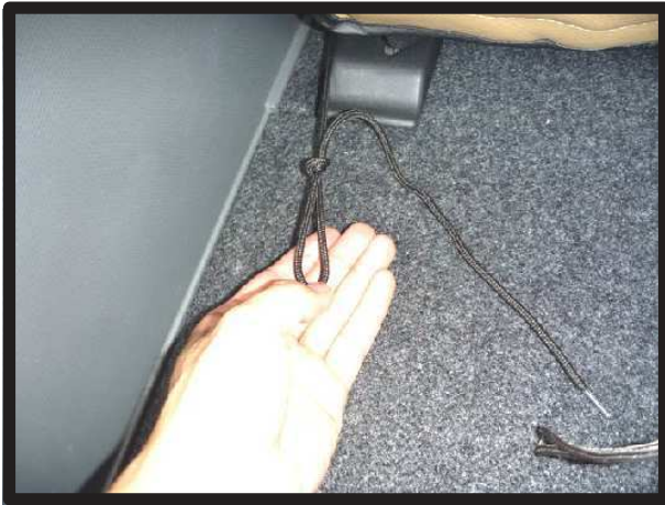
⑩カバー側面から出ているヒモの片側で、図のような輪を作ります。
