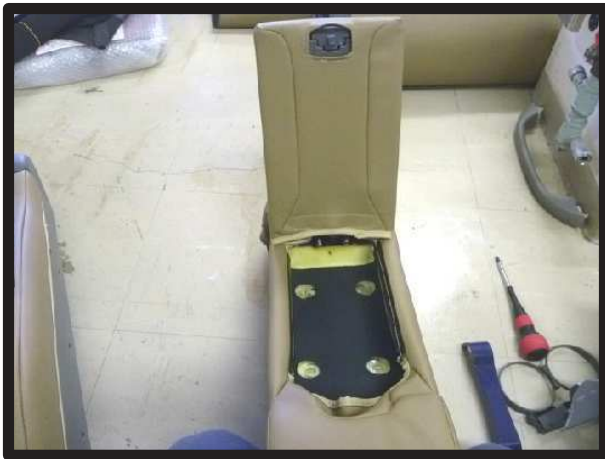
⑪ボックスが収まる部分の生地を整えます。カバーに付いているプラスチックの板を、ボックスの収納部に入れ込みます。上ボタンを元に戻します。
