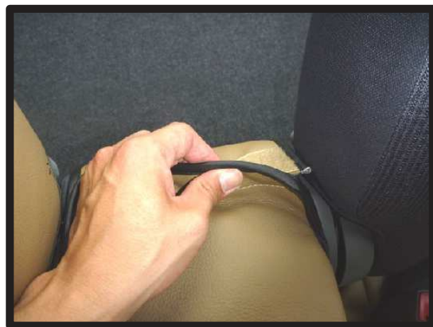
③アームレストを倒して入れ込んだ生地を引き出し、マジックテープで固定します。
