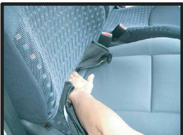
③座面と背もたれの間にカバーの後ろ側を入れ込みます。
