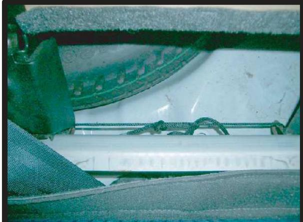
④カバー左右のひもをシートの後ろ側にまわします。トランクと背もたれの間の板を開けてひもを取り出し、結んで固定します。
