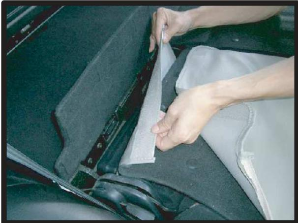
④シートを倒してトランクと背もたれの間の板を開け、②で入れ込んだ部分のマジックテープを固定します。
