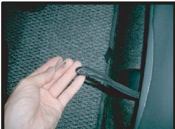
⑤座面カバー前側のゴムに付属の金属フックを取り付け、座面下に固定します。
