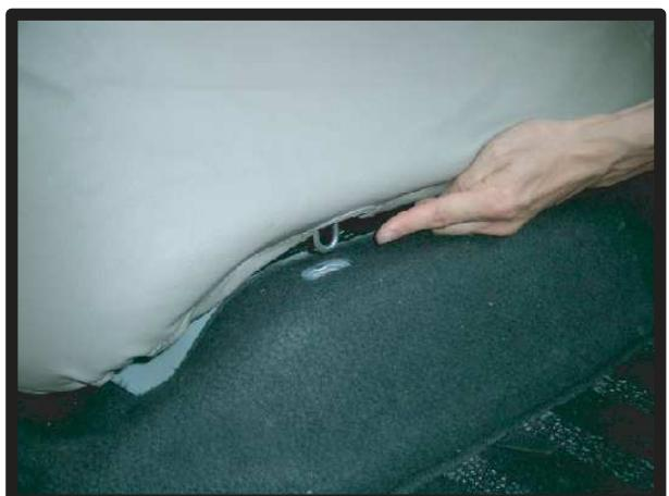
⑨座面前側のフックを車体の穴に合わせて上から押し込み、固定します。
