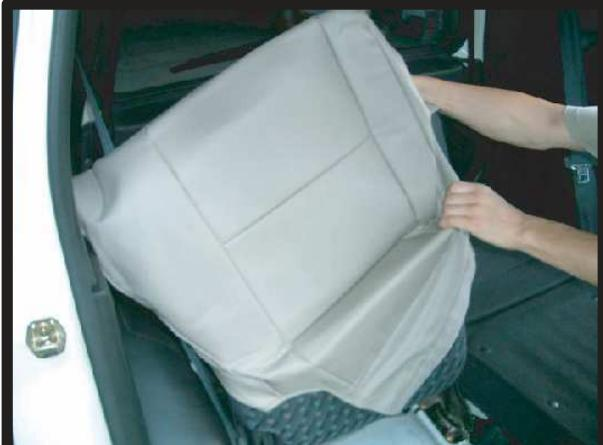
①背もたれカバー裏側のファスナーを開けてシートにかぶせます。車体外側から途中まで入れた後、反対側を入れ込みます。
