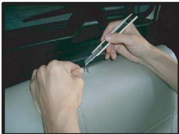
⑥2列目ヘッドレスト付き車の場合は台座部分の穴あけ加工が必要です。正確に位置決めをした上、カッター等で台座よりも小さめの穴を開けます。シート本体に傷を付けないようご注意ください。
