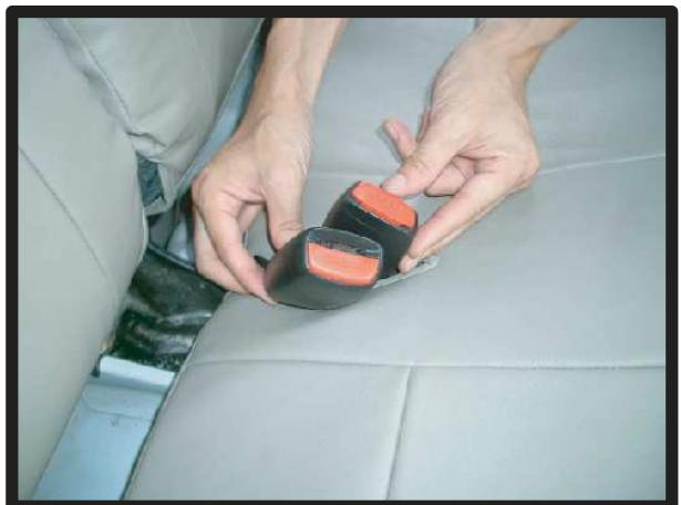
⑧座面シートを外した時と逆の手順で取り付け直します。シートベルトの受け側を元の位置に収まるようにして下さい。
