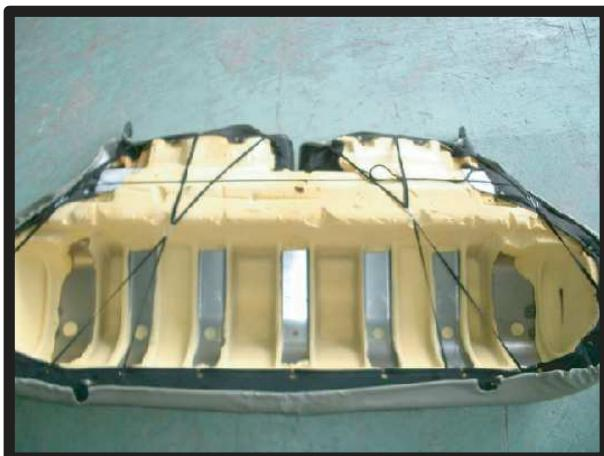
③座面を裏返してひもを1列目と同じく結びます。シートカバー前後のゴムを付属の金属フックで固定します。
