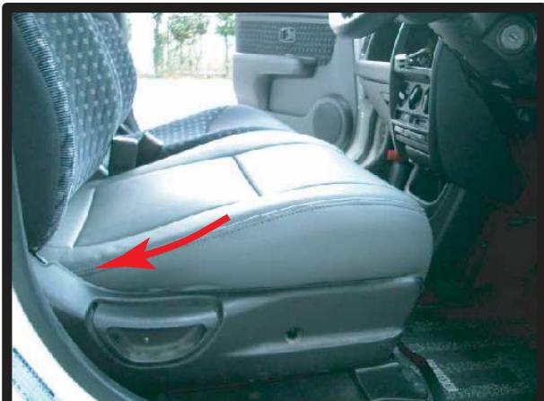
⑤カバー側面のひもを隙間から座面後ろ側へ通します。
