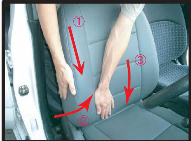
④①～③の順番にカバーをなで下ろしてシートに密着させるようにしわをなくしていきます。
