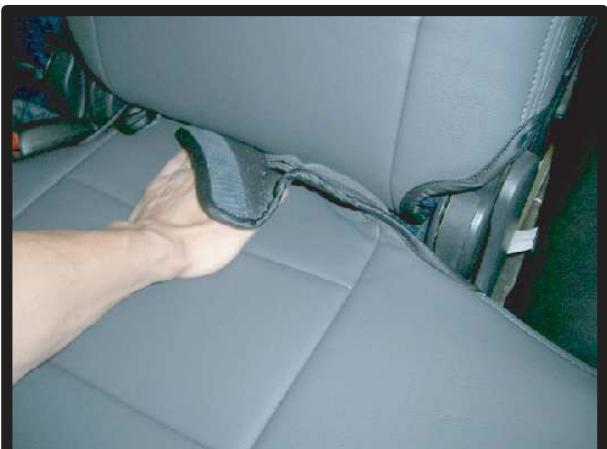
②座面カバーをシートにかぶせます。座面と背もたれの間にカバーを入れ込みます。
