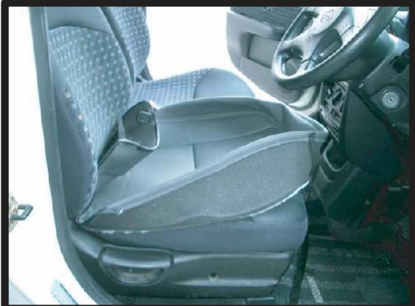
①運転席の座面カバーを図のように裏返して、シートのラインに合わせます。
