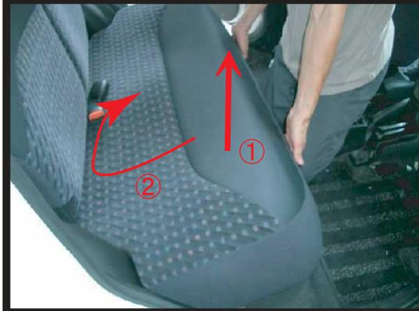
①座面を車体から取り外します。図のように前側を持ち上げてから後ろ側へ押し込んだ後、手前に引き抜きます。
