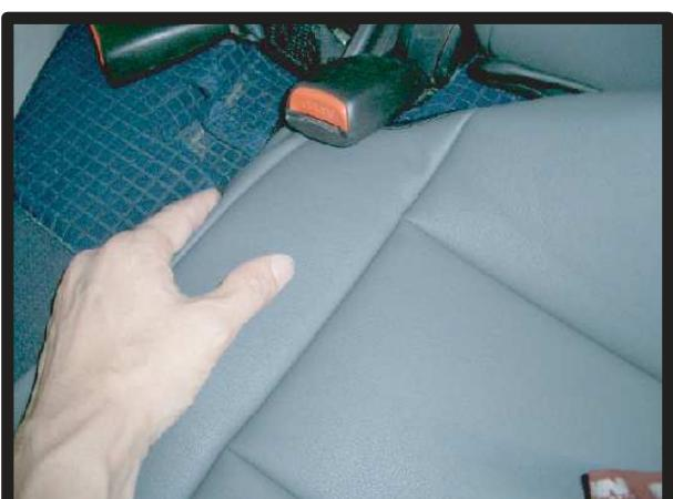
③内側の側面にカバーを入れ込みます。座面の隙間が非常に狭いので、シートを前後に調節するなどして奥までしっかりと入れ込みます。
