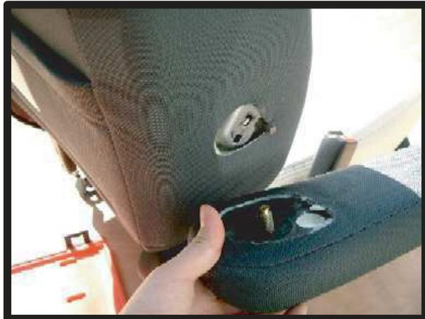
①ソケットレンチ等でアームレストを固定しているボルトを外します。潤滑用グリスでシート本体を汚さないようご注意ください。
