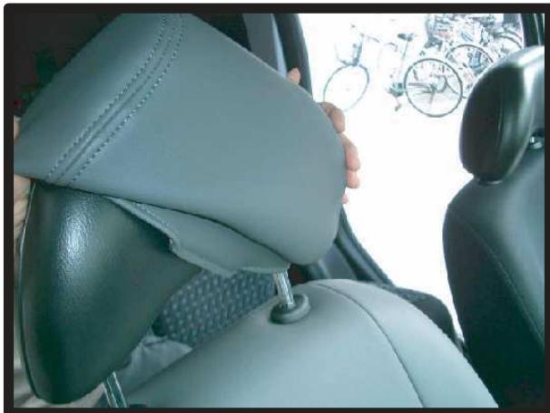
①ヘッドレストカバーの前後を確認してからかぶせます。平らなプラスチックの部品が付いているほうを前にして片側を引っ掛けるようにかぶせます。
