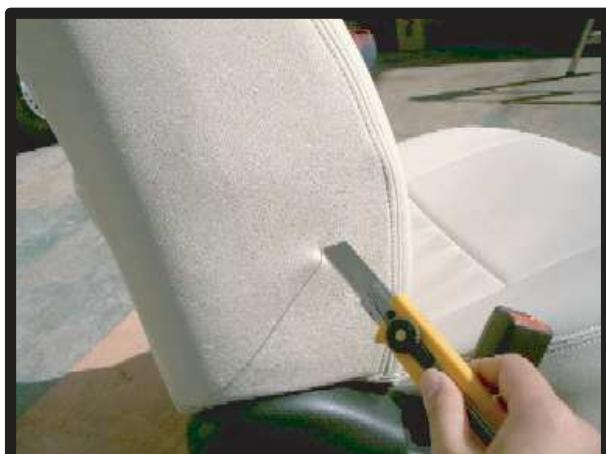
②背もたれカバーを正確な位置に取り付けた後、ボルトが入る位置に穴を開けます。シート本体に傷を付けないようご注意ください。
