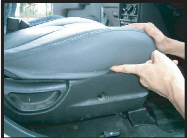
④カバー側面部分をプラスチックカバーの中に押し込んでいきます。
