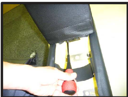
⑫上フタを本体に固定します。ネジはしっかりと締めて下さい。上フタの固定がずれると、上フタのロックがかりづらくなります。
