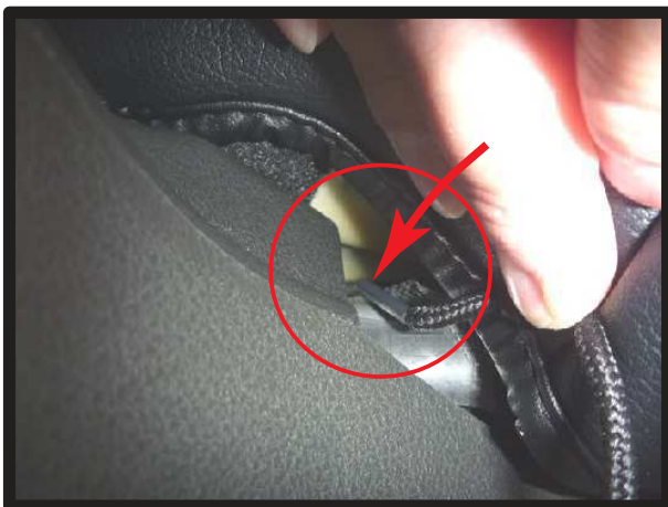
⑨カバー外側面のヒモは、図のように座面付け根の隙間から落とし込み、シート裏側から引き出します。
