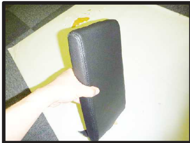
⑥⑤の丸印部分に注意しながら上フタ全体にカバーをかぶせます。
