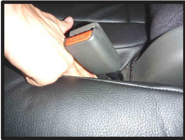
⑦シートベルト周りの生地を入れ込みます。
