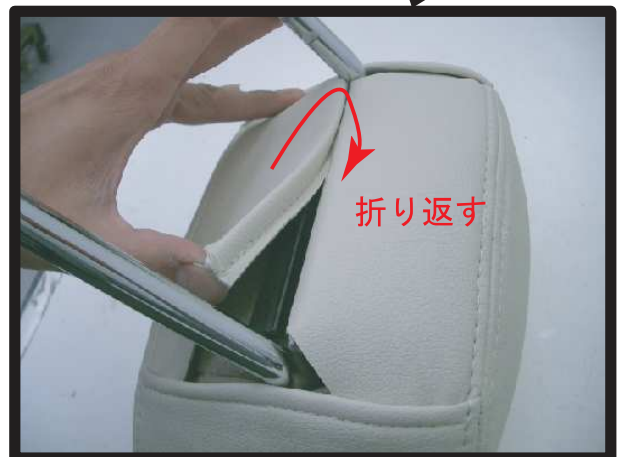
⑤アームレストと同じように取り付けます。 平らなプラスチックを生地を巻き込む形で、カギ状のプラスチックフックに差し込んでいきます。
