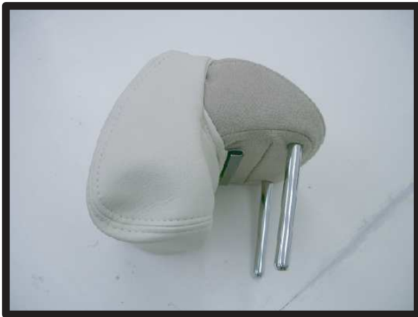
①前側からカバーを被せていきます。
