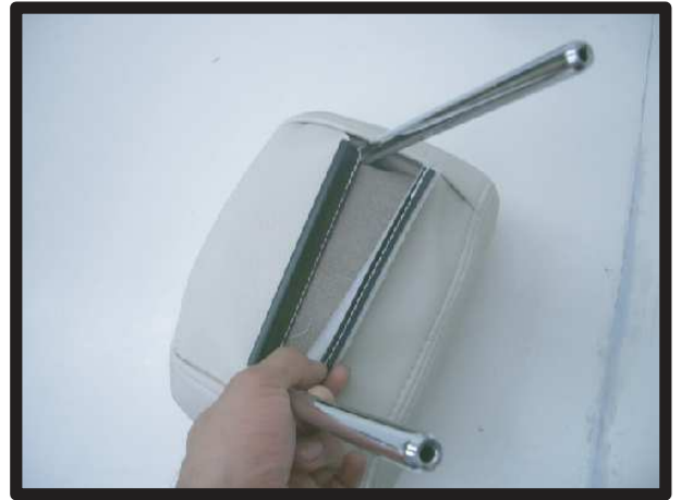
④裏面を向けて、プラスチックのフックどうしを取り付けます。
