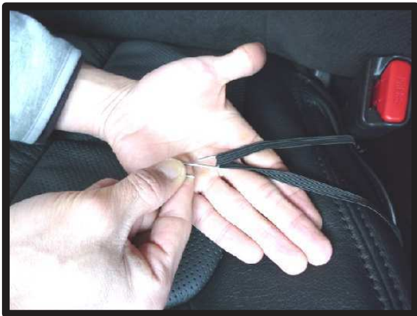
⑦シートの内側側面部分です。カバー側面に付いているゴムに付属のS字フックを取り付けます。
