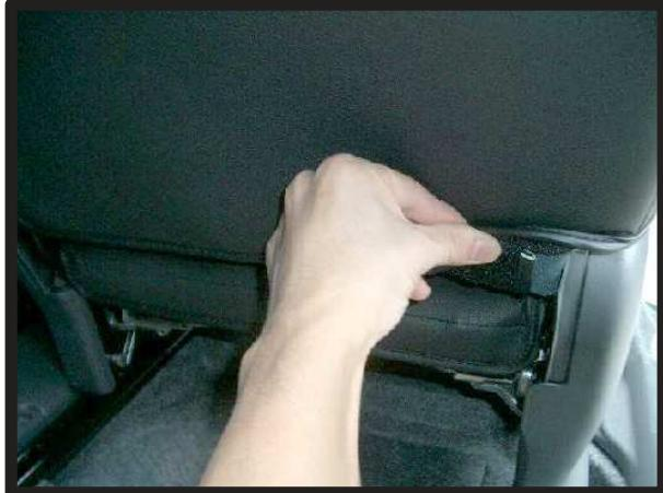
④裏側に引き出したマジックテープ部分を固定します。アームレスト下部のマジックテープも固定します。
