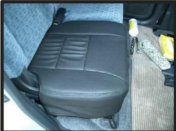
①座面カバーをシートのラインに合わせてかぶせます。背と座面の間にカバーを入れ込み、マジックテープで固定します。
