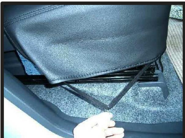
②前と左右のゴムを座面裏のフレーム等に引っ掛けで固定します。ゴムは2本ずつ金属フックにかけて固定してください。
