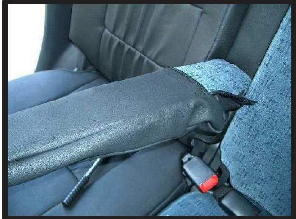
⑤アームレストを元通り取り付けてアームレストカバーをかぶせ、マジックテープで固定します。
