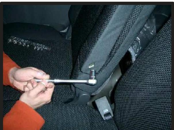
③アームレストを外します。ふたをマイナスドライバーなどで外し、中のナットを外します。
