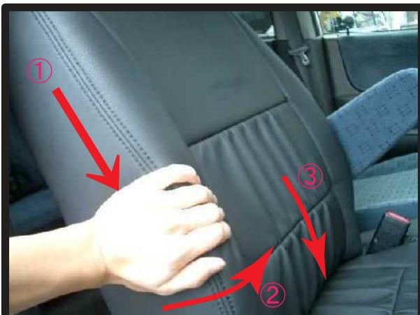
②①～③の順番にカバーをなで下ろしてシートに密着させるようにしわをなくしていきます。座面と背もたれの間にカバーを入れ込み、裏側から引き出します。
