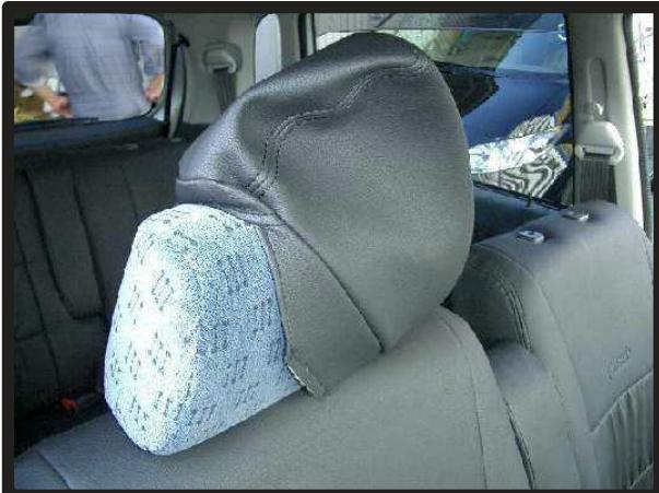
①ヘッドレストカバーの前後を確認してからかぶせます。平らなプラスチックの部品が付いているほうが前です。図のようにヘッドレストの端に引っ掛けるようにします。
