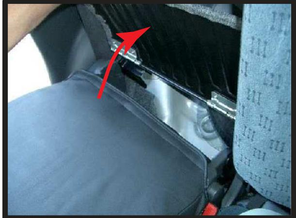
④1列目と同様に背もたれカバーをかぶせます。トランクと背もたれの間にある板を開けてシートカバーを引き出し、マジックテープで固定します。
