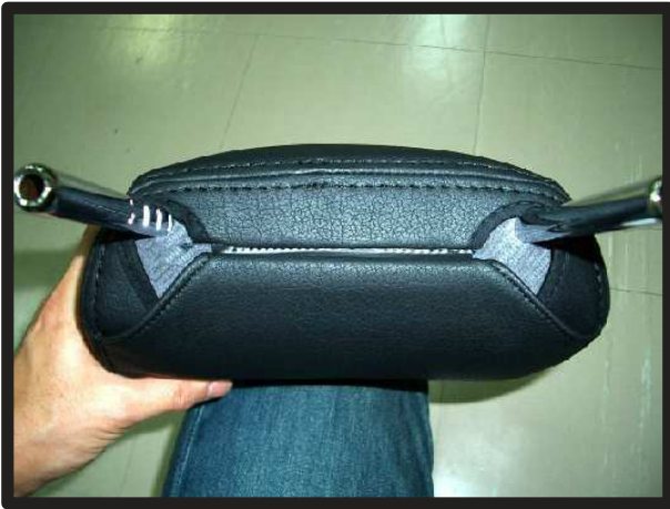
④プラスチック部とフック部を固定した状態です。
