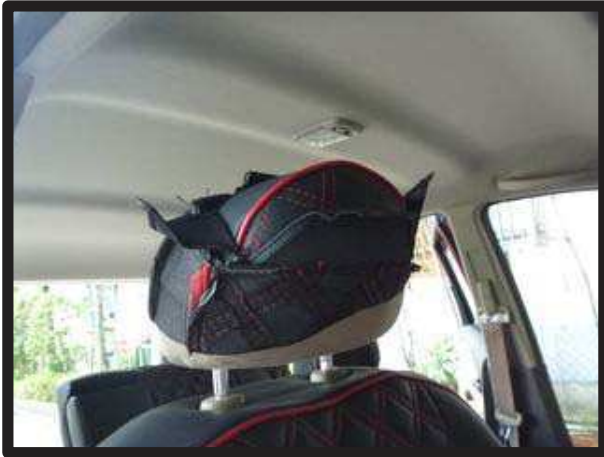
①カバーを半分程裏返し、ヘッドレストのラインに合わせます。
