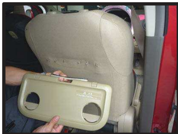
⑤運転席シートバック格納式テーブルを背もたれから外します。
