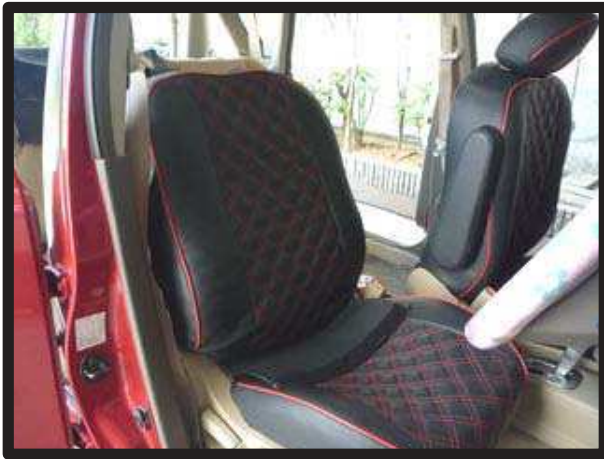
⑦シートのラインに合わせてながらカバーをかぶせます。
