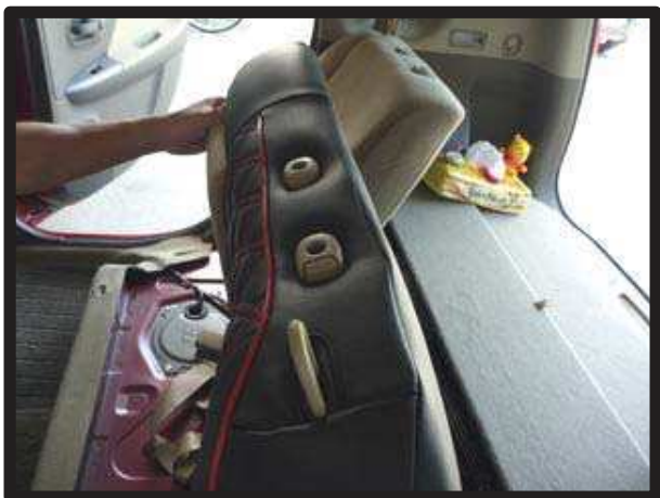
⑯ヘッドレストの台座部分をカバーの加工穴から取り出した図です。 取り出し方法は、5ページ図⑦と同様です。
