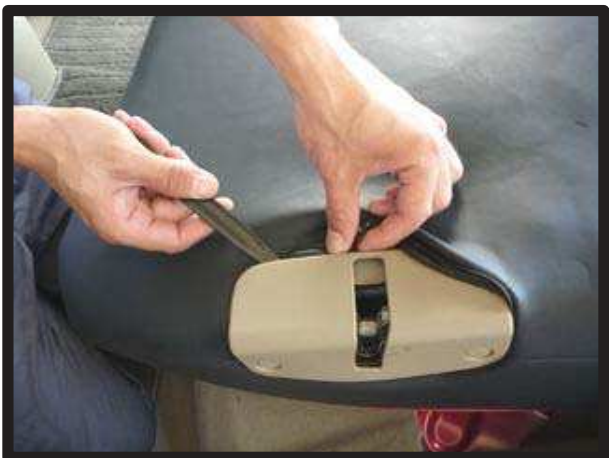
⑮シート側面の生地をヘラ等を使用し、シートとプラスチック部の隙間に入れ込みます。
