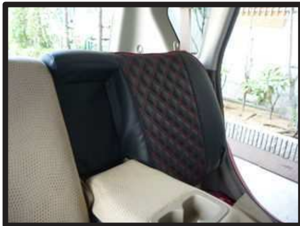
⑭カバーのラインを整え2列目助手席側背もたれの完成です。 運転席側、2列目アームレスト無し車も一部形状は異なりますが、同様の固定方法で取り付けます。
