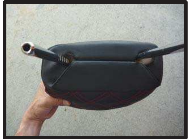
⑤プラスチックフックで固定したヘッドレストの裏側の図です。
