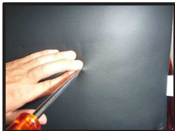
⑭ボルトの位置に合わせて生地に穴を開けます。
