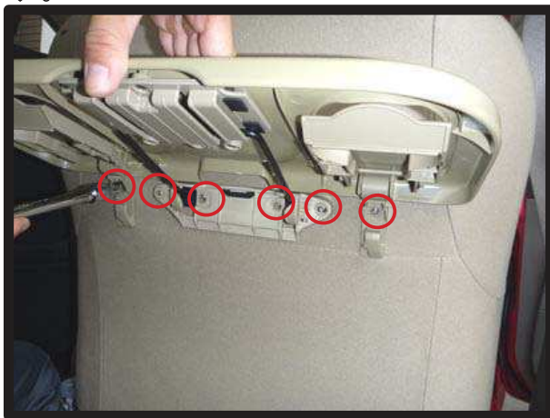
④ラチェットレンチ等で運転席シートバック格納式テーブルを固定しているナットを外します。
