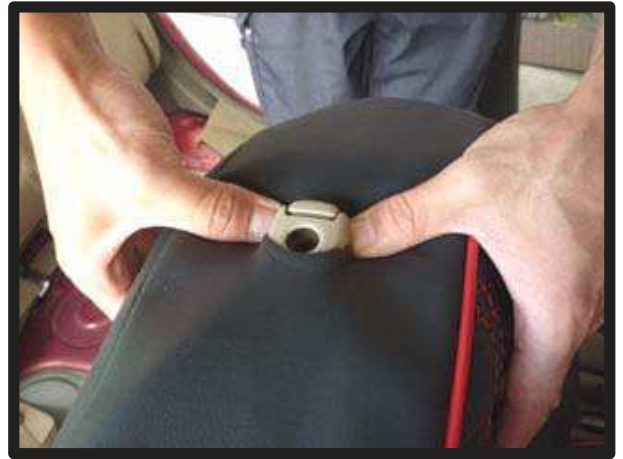
⑩ヘッドレストの台座部分をカバーの加工穴から取り出します。生地伸びを利用して横から潜り込ませるように取り出します。
