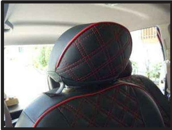
②左右均等に生地を引き下げながらカバーをかぶせます。 無理な力かけるとカバーが破れる恐れがありますので慎重に作業して下さい。
