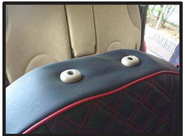
⑪ヘッドレストの台座部分をカバーの加工穴から取り出した図です。
