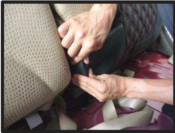
⑦アームレスト下部分のカバーをシート のラインに合わせます。
