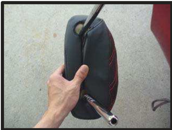
③取り外したヘッドレストの裏側はプラスチックフックで固定します。
