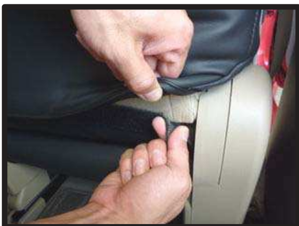
⑮カバーの背面下と4ページの図⑨で引き出した生地をマジックテープで固定します。
