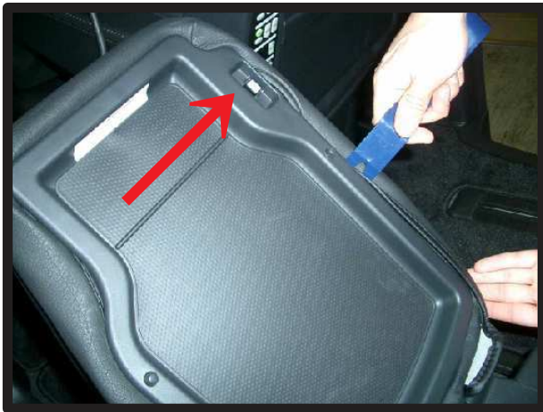
⑧H16/8以降の車は座面裏のフチに生地を入れ込みます。→部分は隙間がほとんどないため生地は入りません。力を入れすぎると生地を傷つける為ご注意ください。
