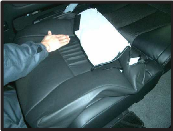
①座面外側の角からカバーをかぶせます。
