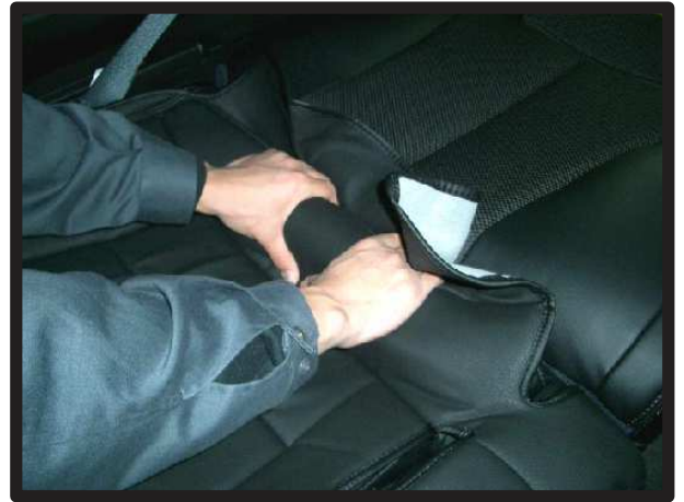
④シートを正常の位置に戻し、背もたれと座面の隙間に生地を入れ込みます。入れ込んだ生地を背面から引き出します。
