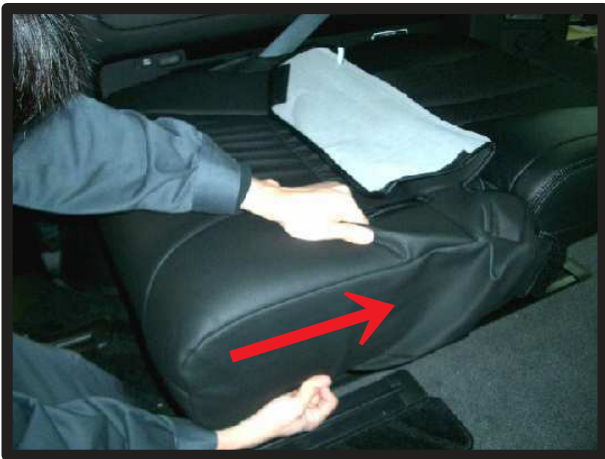
②内側の角にカバーをかぶせます。→の方向にしっかりと入れ込んで下さい。
