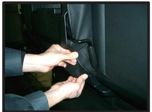
⑥シートを跳ね上げ、シート裏で前側からの生地をシート背面の生地とマジックテープで固定します。
