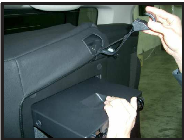
③シートを跳ね上げ、座面裏のフックをカバーの加工穴から出します。
