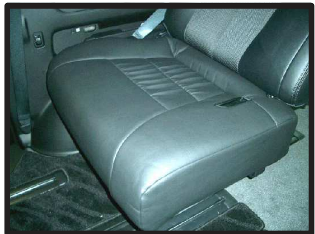
⑫シートのラインを整えて3列目座面の完成です。助手席側も同様の取り付け方法で行います。
