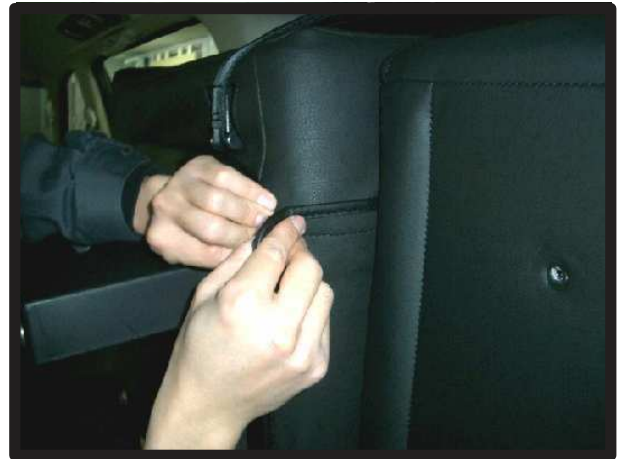
⑤座面後ろをマジックテープで固定します。
