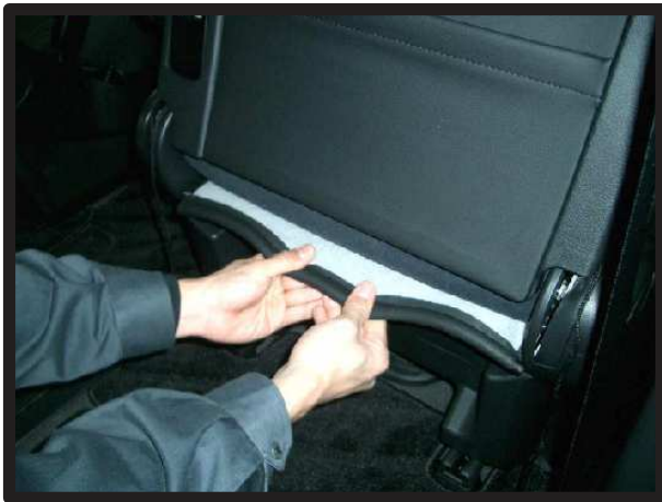
⑧ 入れ込んだ生地を背面から引き出します。
