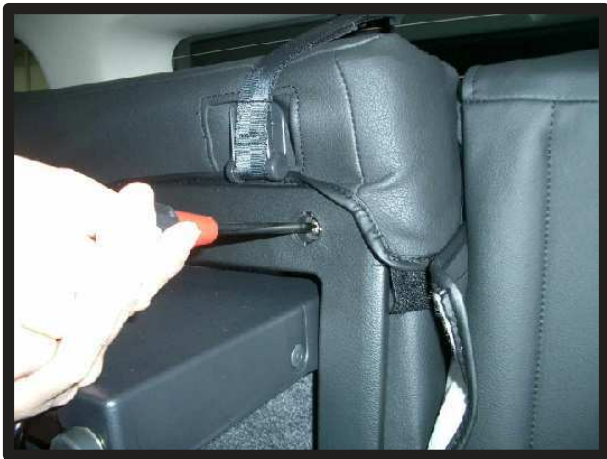
⑧ドライバーを使いネジを抜きます。ネジを抜くとプラスチックのカバーが緩みます。
