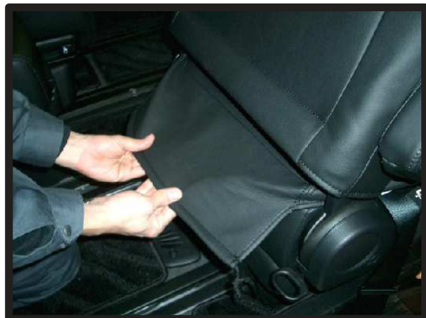
⑤入れ込んだ生地を背面から引き出します。
