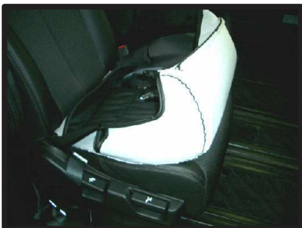
③カバーを裏返してシートのラインに合わせます。
