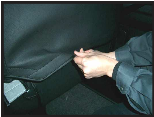
⑧背もたれ裏下部分と③で引き出した生地をマジックテープで固定します。
