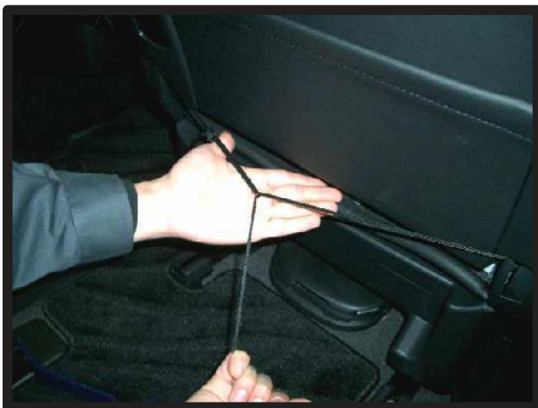
⑨ カバー側面のヒモを、背もたれ背面下で絞り込み結び留めます。ヒモはプラスチック部分の下にもぐり込ませて下さい。
