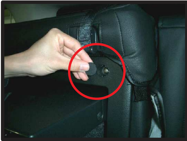
⑦座面裏のプラスチックカバーを緩めます。まず写真○印のフタを取ります。フタは前後2箇所あります
