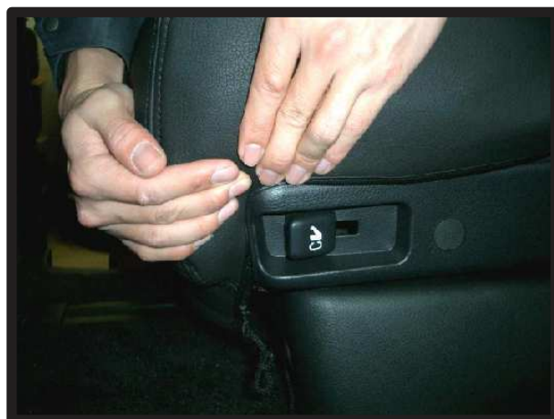
⑥カバー側面の生地をシートのプラスチック部分に入れ込みます。
