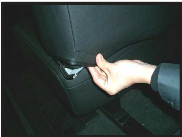
⑨背もたれ内側のヒンジを避けているところも前後でマジックテープで固定します。
