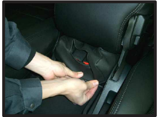
⑩補助席留め具の収納部分にカバーをかぶせます。
