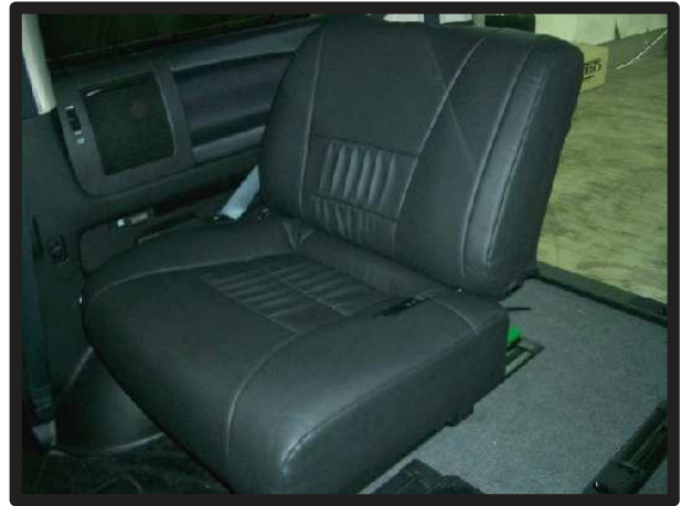
⑩ラインを整えて3列目背もたれの完成です。 助手席側も同様の取り付け方法で行います。
