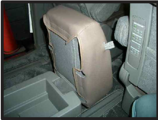
⑦H14.5～H16/8までの車は座面裏でマジックテープで固定します。
