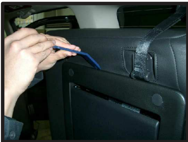
⑨プラスチックカバーを緩めたらその隙間に生地を入れ込みます。
