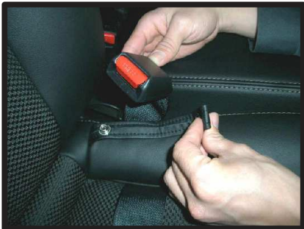
①シートベルト留め具の固定を外しておきます。
