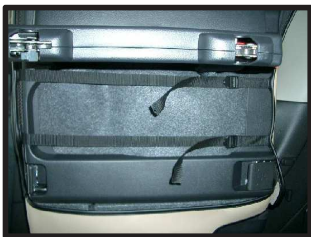
③座面カバーの前後に付いているベルトをプラスチックカバーの上から固定します。
