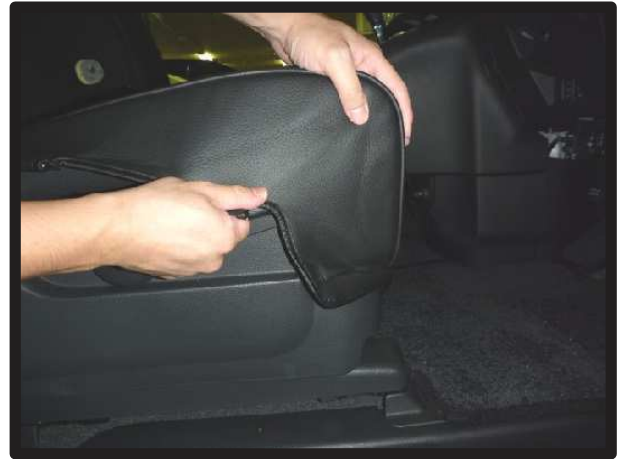
⑩ カバーの側面をシートのラインに合わせてみます。
