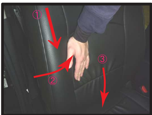
⑫図の①～③の順番で生地をシートに馴染ませ、カバーのシワを無くしていきます。
