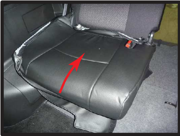
①シートのラインに合わせて、カバーを前側からかぶせます。
