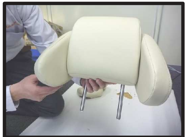
⑫ヘッドレスト両端を下げると、このようになります。
