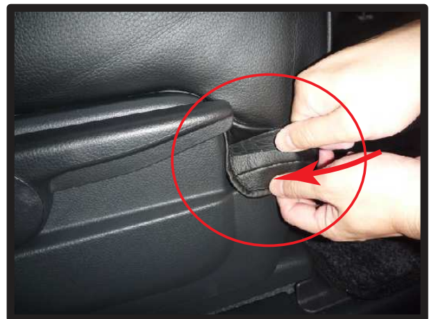
⑫ 図の位置の生地は、シートの側面から底面にかけて、入れ込みます。
