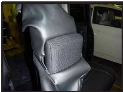
⑦図のようにカバーの加工穴から、アームレストを通します。
