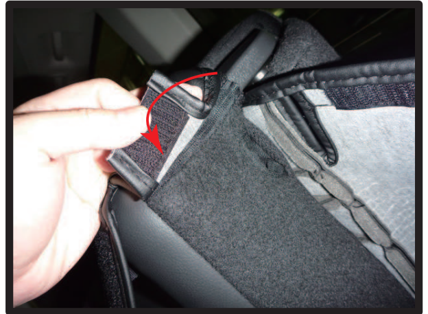
⑤シートを跳ね上げた状態で、内側側面の生地をシート後ろ側へマジックテープで直接固定します。
