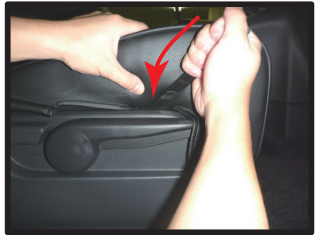
⑪ シートのプラスチック部に、カバーの生地を入れ込みます。
