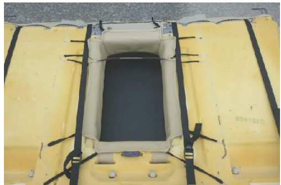
17 アームレスト収納部に収まる生地の端にゴムが付いています。ゴムに付属のS字フックを取り付けて、アームレスト収納部の生地がしっかりと張るように固定します。
