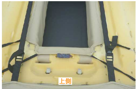
18 シート裏の上側です。上側の生地は斜め上方向へ、側面側の生地は横方向へ生地が張るようにゴムを固定します。
