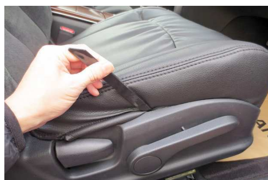
11 シート外側面のシートとプラスチック部の隙間に、ヘラなどを使用して生地を入れ込みます。
