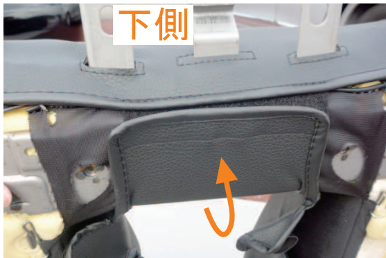
14 アームレスト収納部の下側をカバーで覆いながらマジックテープを止めます。
