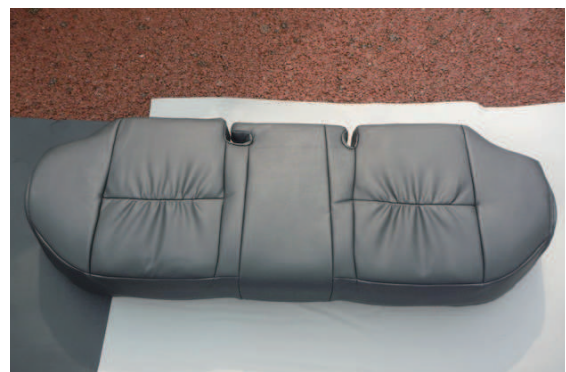
12 カバーのラインを整えて、2列目座面の完成です。シートは背もたれカバーを装着後、背もたれシートを先に車体に戻した後に、元に戻します。
