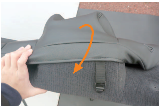
15 シート上部のヘッドレスト部にカバーを被せます。
