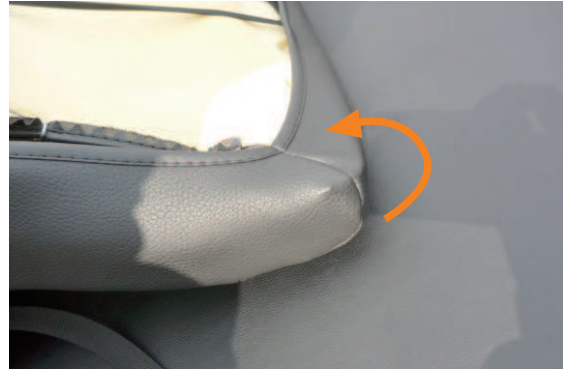
16 シートの角にカバーを引っ掛けるようにして被せます。
