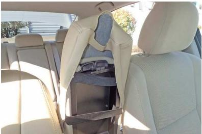
1 カバーの前後を確かめてアームレストの先端からカバーをかぶせます。カバーの前後は加工穴がある方が前です。
