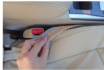
12 カバー内側面に付いているマジックテープを、シートに直接貼り付けて固定します。
