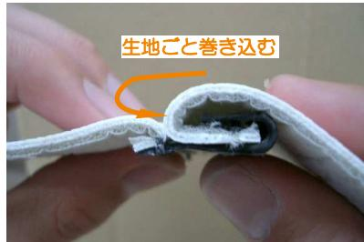
26 プラフックは板状のプラスチックを生地と一緒に折り返して、フック側に巻き込むように入れ込み固定します。
