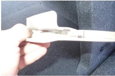
34 5番で外したプラスチックパーツを元に戻します。外すよりも戻す方が難しい作業です。戻す前に裏側を見て、ツメの位置を確認しておきます。
