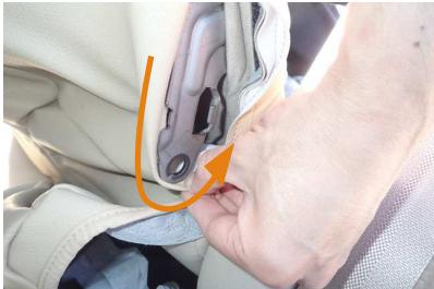
13 5番でプラスチックパーツを外したアームレストの軸部分に、カバーの加工穴を通しておきます。加工穴は広めに開けていますが、力を入れすぎると生地が裂ける恐れがあるので、作業は慎重に行って下さい。
