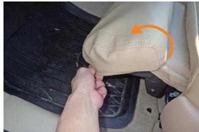
10 オットマンのカバーは固定部材が付いていません。前後で引っ掛けで固定します。まずオットマンの角を合わせながら図のようにカバーをかぶせます。付け根側からカバーをかぶせて、前側にも引っ掛けるようにならべます。
