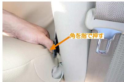
31 車体側の金属フレームをしっかりととかわしながらアームレストを戻していきます。アームレストの角を指で押しながら、慎重に戻します。
