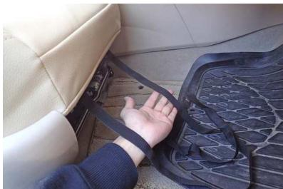
14 カバーの前側に付いている2本のベルトをシート裏を通して背面へ回します。
