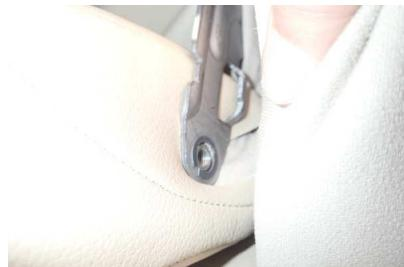
32 アームレストのネジ穴と金属フレームの穴位置をしっかりと合わせます。
