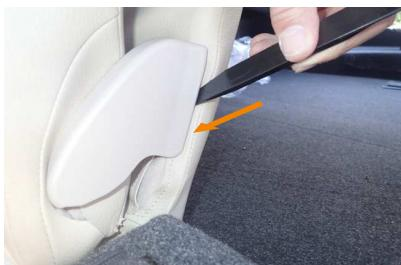
36 助手席側からプラスチックパーツの隙間に生地を入れ込みます。
