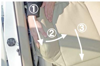
5 ①～③の順番に、カバー側面の生地を引き下げながら中央へ寄せて、中央で余った生地を下へ撫で下ろします。シートの下に余った生地を④番と同様にシート裏から引き出して、生地をシートに密着させていきます。
