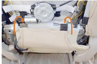
10 5番で引き出した生地に付いているフックを、純正シート地のフックを固定している金属のフレームに引っ掛けて固定します。
