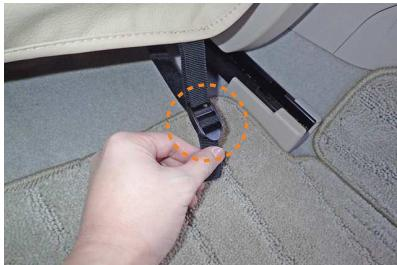
7 8ページ3番で入れ込んだ生地を背面から引き出します。引き出した生地に付いているバックルにベルトを通して、運転席と同様に固定します。
