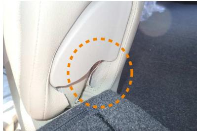
37 プラスチックパーツの下部分は、カバーをかぶせる際に金属パーツをかわせるように大きめに穴を開けているため、シート地が見えます。こちらはご了承下さい。
