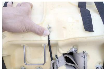
11 金属フックをシート裏の金属フレームに引っ掛けで固定します。
