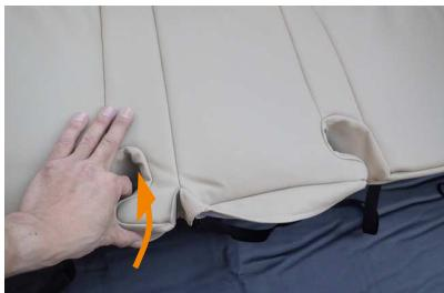
8 シートベルトバックルが出てくる図の部分に、シートの形状に生地を添わせるように入れ込みます。
