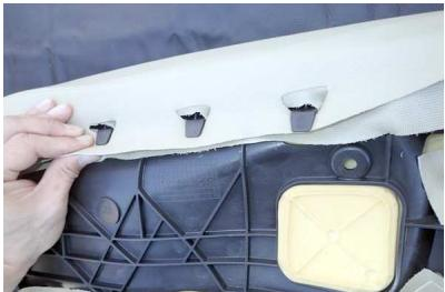
5 カバーを純正シート地が固定されているのと同じ様に、ツメ部分に生地の切り込み部分を引っ掛けていきます。
