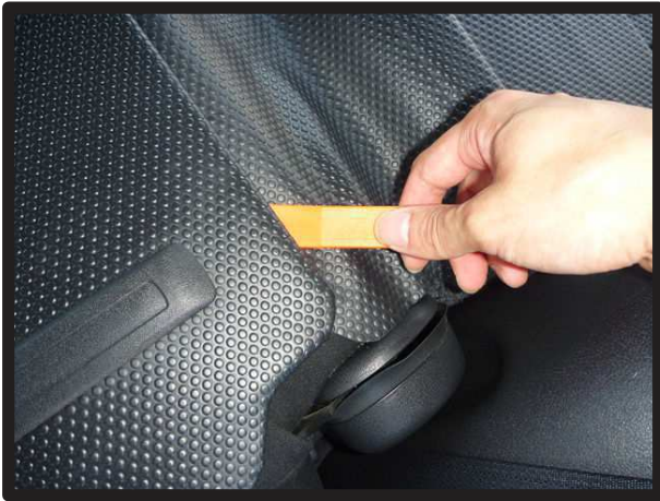
①背もたれを前方に倒し、ボードの留め具（ピン）をヘラなどを使用し、慎重に取り外します。
