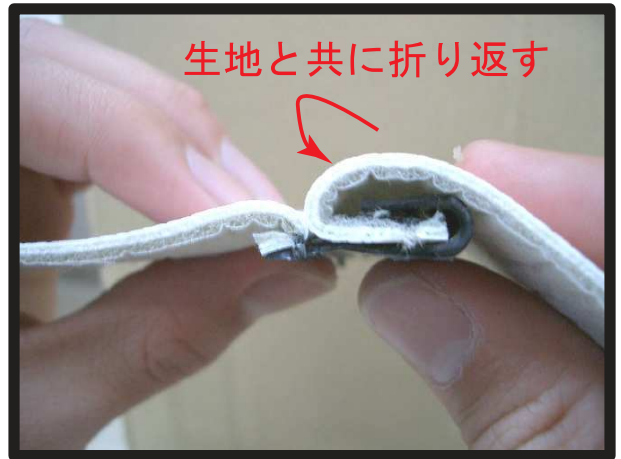
⑦フックはカギ状になっているプラスチックに板状のプラスチックを、生地と共に折り返して挟み込み、固定します。
