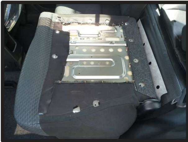
②ボードを取り外すと写真のような状態になるので、この上からシートカバーを取り付け、10ページからの2列目背もたれの説明手順に沿ってカバーを取り付けていきます。
